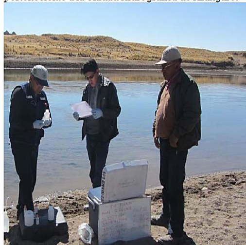
FOTOGRAFÍA N° 10.- Muestreo de la calidad del agua en el Río Azángaro, 250 m aguas abajo del punto de vertimiento, punto N° 12 de la red de muestreo perteneciente a la Unidad Hidrográfica de Azángaro.
