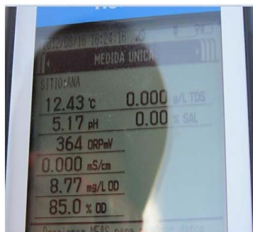
FOTOGRAFÍA N° 08.- En todo punto de muestreo se realizó la medición de parámetros in situ como: Temperatura, pH, oxígeno disuelto y conductividad eléctrica, se trabajó con el equipo Multiparámetro marca HQ40d.
