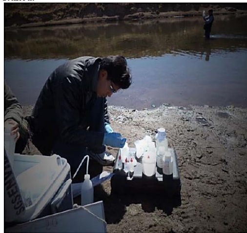
FOTOGRAFÍA N° 10.- Muestreo de la calidad del agua en el Río Azángaro, 250 m aguas abajo del punto de vertimiento, punto N° 12 de la red de muestreo perteneciente a la Unidad Hidrográfica de Azángaro.
