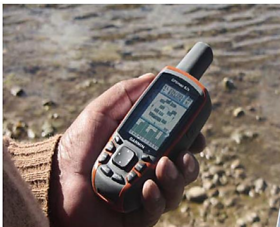
FOTOGRAFÍA N° 08.- En todo los puntos de muestreo se registró la ubicación de fuentes de contaminación y los puntos de muestreo con GPS (Geografical Position System) marca Garmin, en coordenadas UTM en el sistema WGS-84 zona 19
