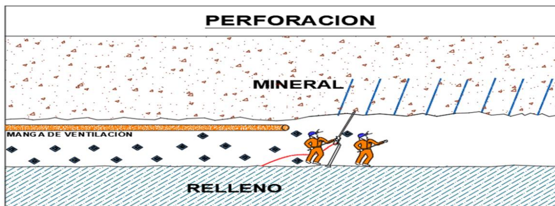
Figura 11: Perforación semivertical con Jack leg
