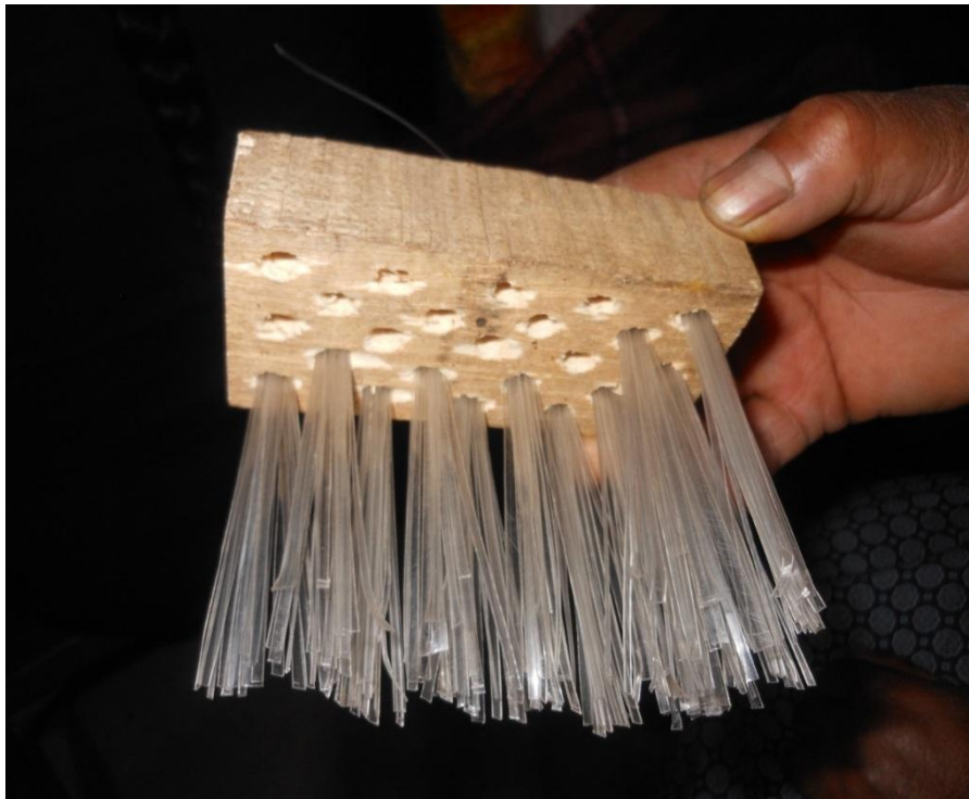
Figura 7. Elaboración de escobillas de material reciclable
