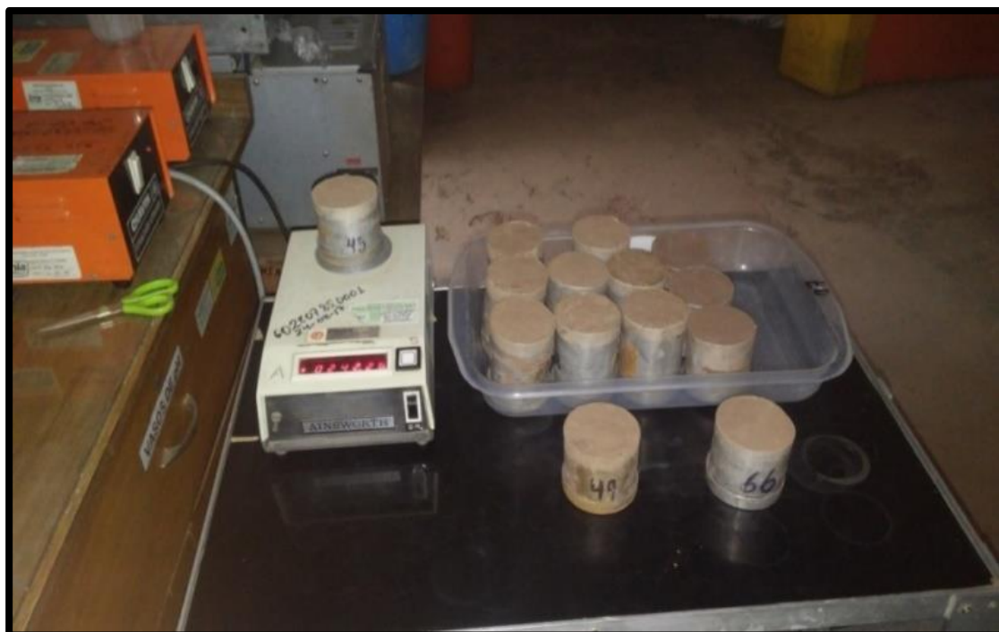
Figura 6. Pesado de las muestras de Humedad
