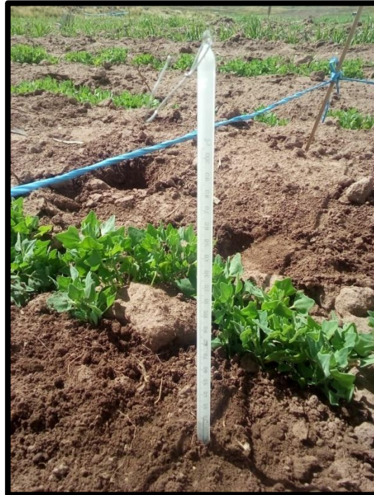
Figura 7. Determinación de la temperatura del suelo
