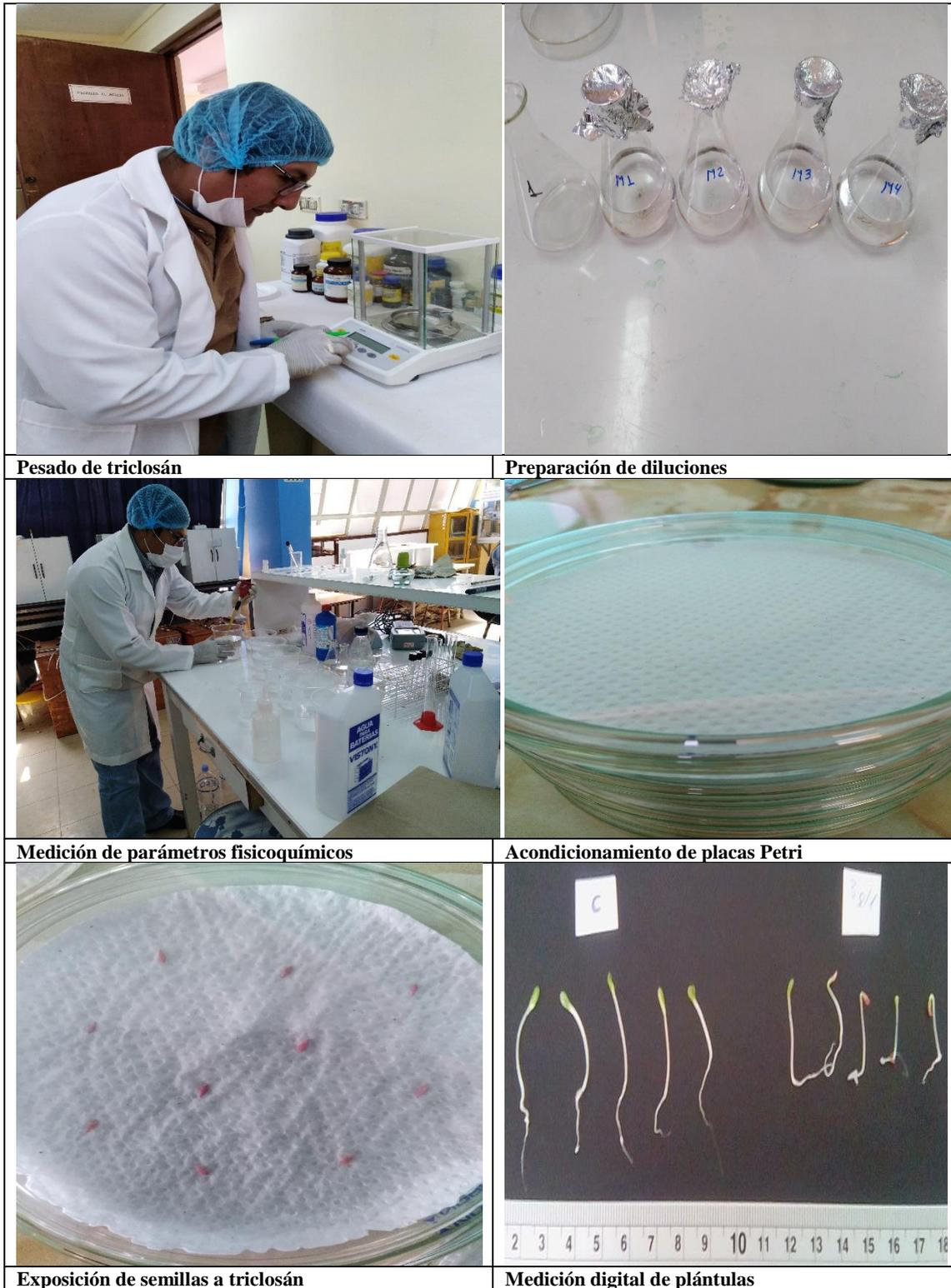
Figura 10. Procedimiento de ejecución del bioensayo con *Lactuca sativa*
