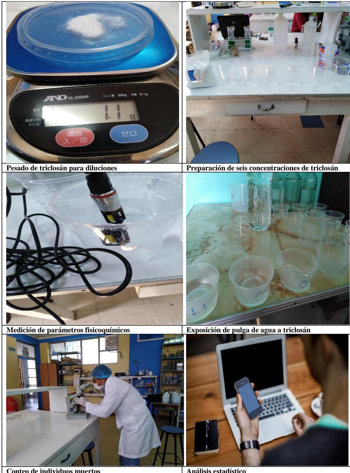
Figura 9. Procedimiento de ejecución del bioensayo con *Daphnia pulex*
