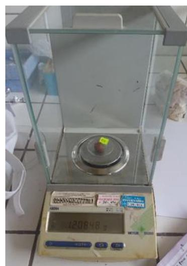
D2: Pesado de fresa después de la prueba
