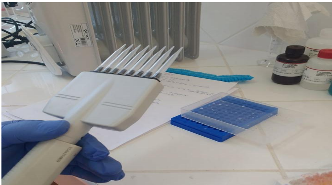
Foto 6: Adición de solución de lavado
