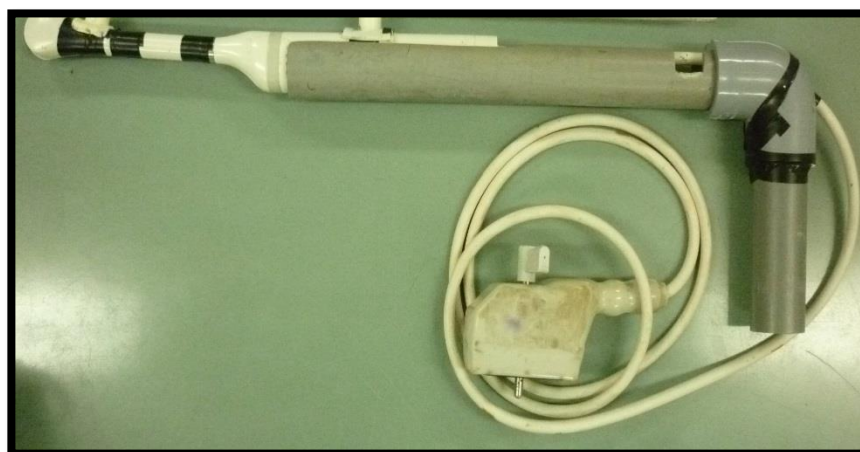
Figura 4. Transductor montado sobre el mango de aspiración
