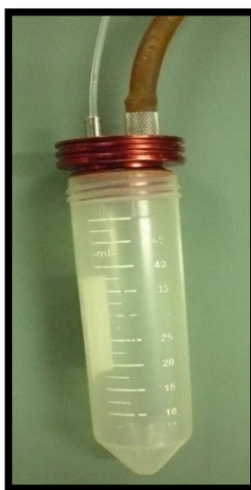
Figura 8. Tubo colector y tapón de vacío
