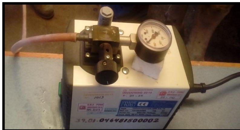
Figura 9. Bomba de vacío para aspiración
