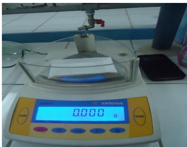
**Figura 57.** Tarando de la balanza analítica.
