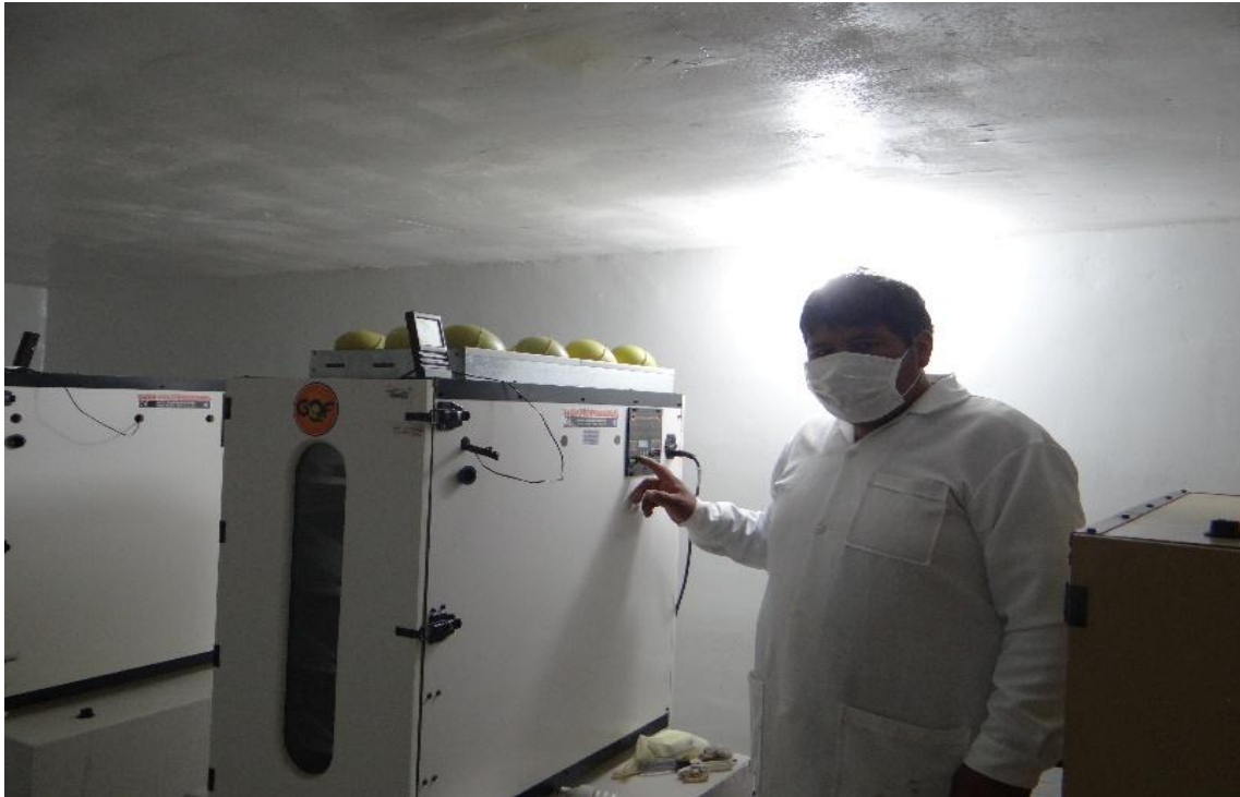
Figura 12: calibración de parámetros de la incubadora, temperatura a 36.4°C y humedad a 44%.
