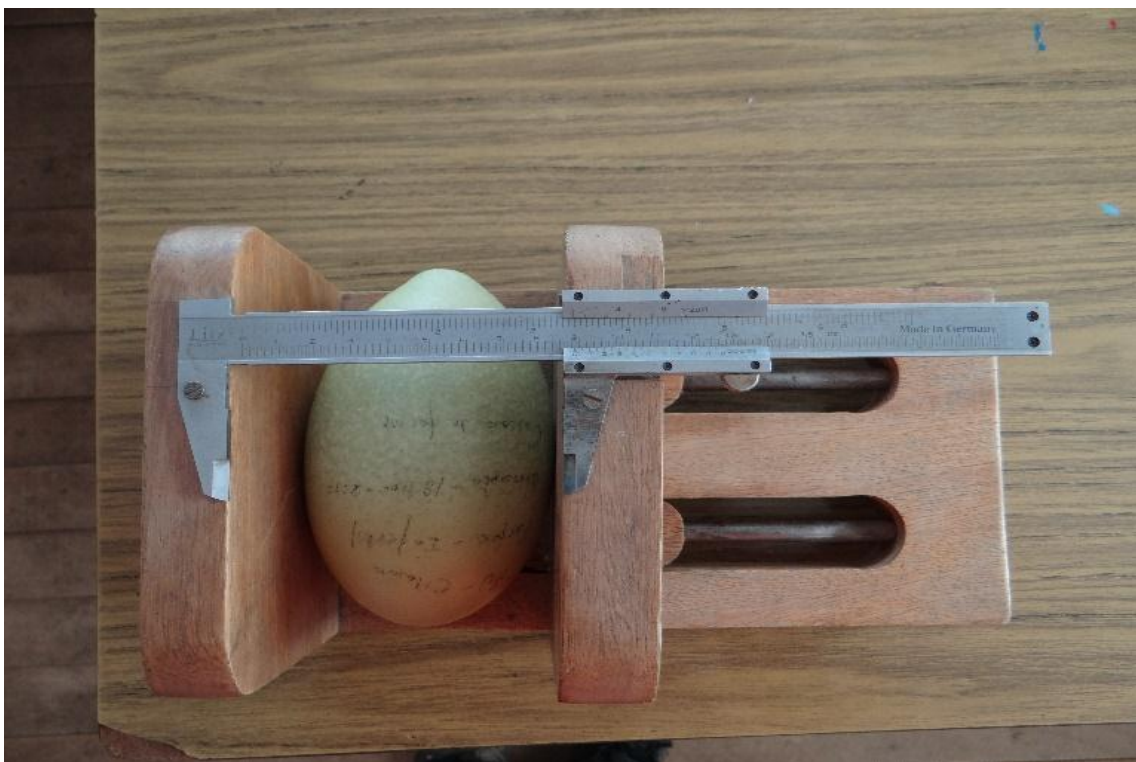
Figura 5: obsérvese la medida de huevo mediante el Ovometro adaptado a la regla vernier
