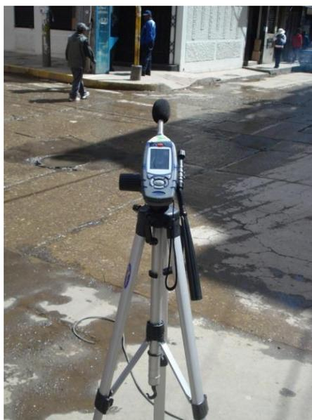
Figura 10. La fotografía muestra el equipo de medición (sonómetro) utilizado, enero – marzo, 2016.
