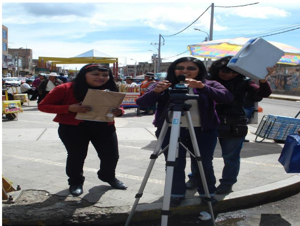
Figura 29: Toma de datos con el sonómetro en Av. Los Incas con Av .el Sol (punto 3), enero – marzo, 2016.
