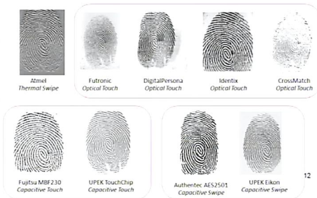
Figura N° 1.1: Capturas de la misma huella dactilar usando diferentes sensores.
