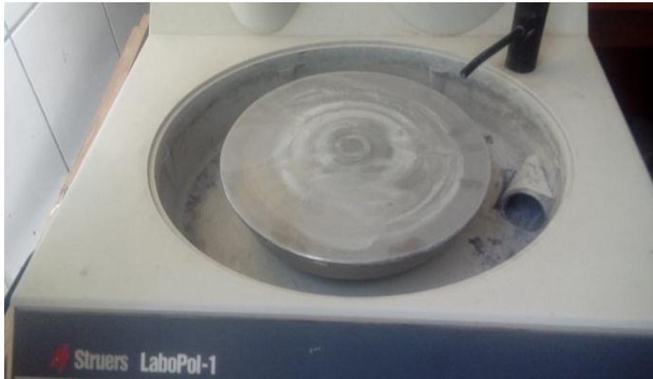
Figura 8: Figura 9. Equipo de pulido fino modelo Strues laboPol.
