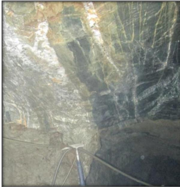
**Figura 15:** Cuerpo Subvolcánico andesítico del Complejo Bella Unión albergando la estructura mineralizada. Presenta una coloración grios con tonalidad azulada con textura porfirítica, presenta plagioclasa. La matriz afanítica está compuesta por cristales de plagioclasa. Dureza fuerte y una densidad media Fuente propia.
