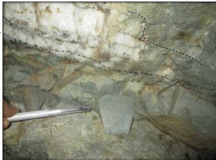
Figura 12: Veta Encantada conformada principalmente con cuarzo limonita con una potencia de 0.20 cmts. Roca encajonante compacta de color gris verdusco con textura porfirítica. fuente propia.
