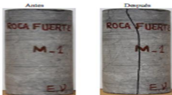
Figura 02: Resultado de la resistencia a la tracción
