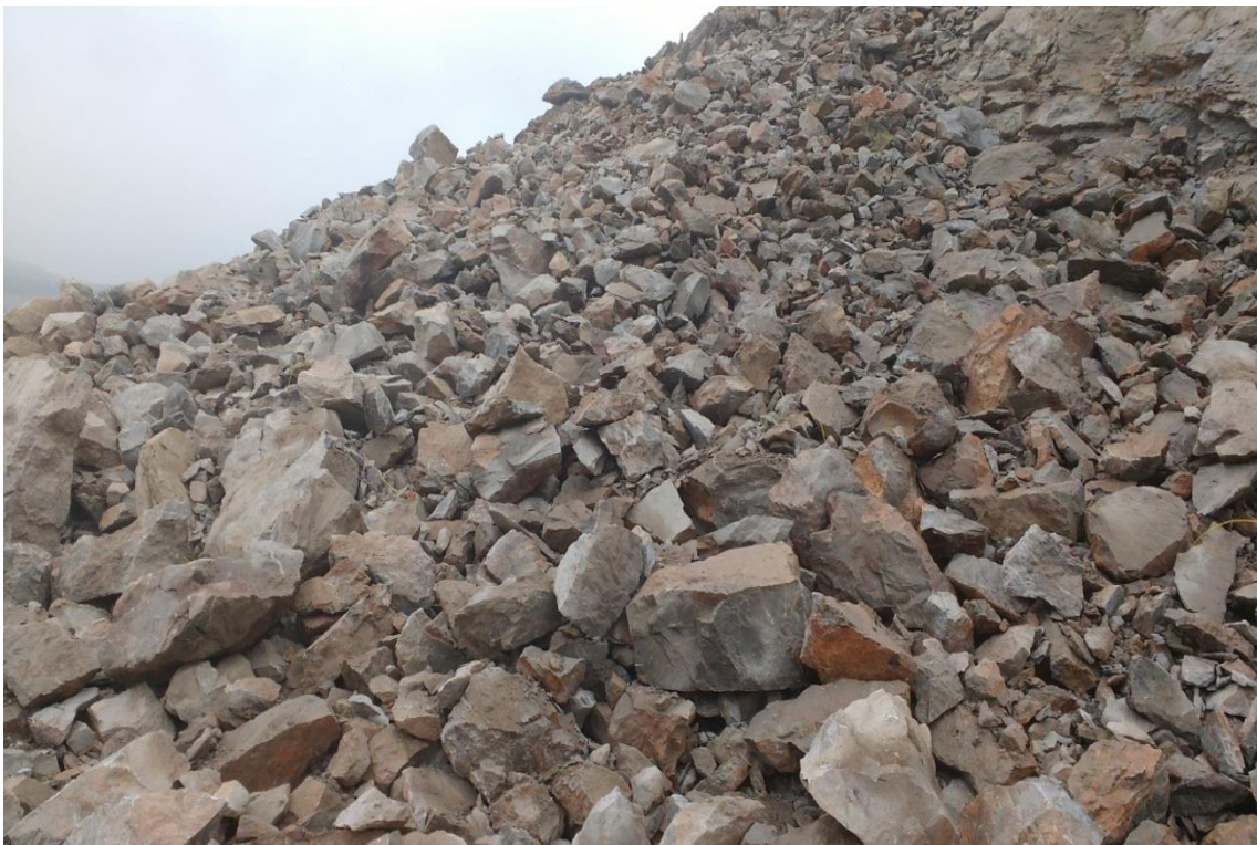
ANEXO “H”: Resultados de la voladura con diseño de malla cuadrada.
