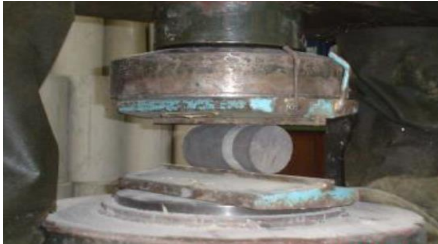
Figura 03: Pruebas realizadas de compresión triaxial.
