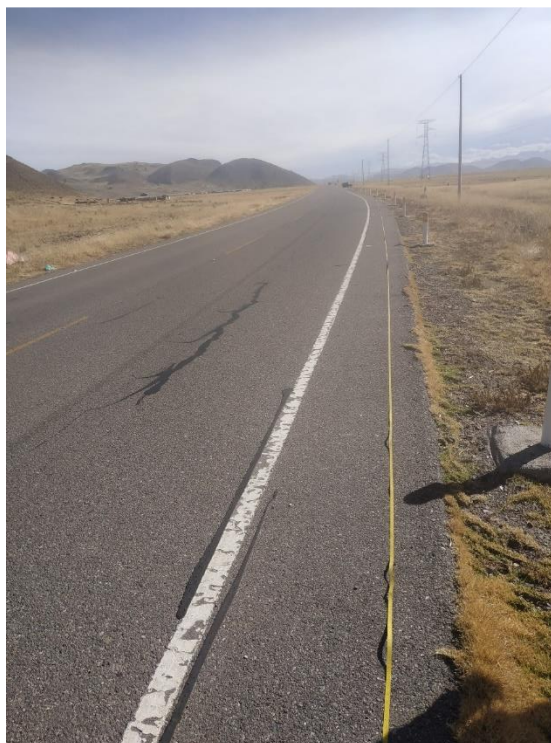
Figura 60. Relevamiento de datos en la sección de evaluación n.º 2 – fallas longitudinales. Fuente: Elaboración propia
