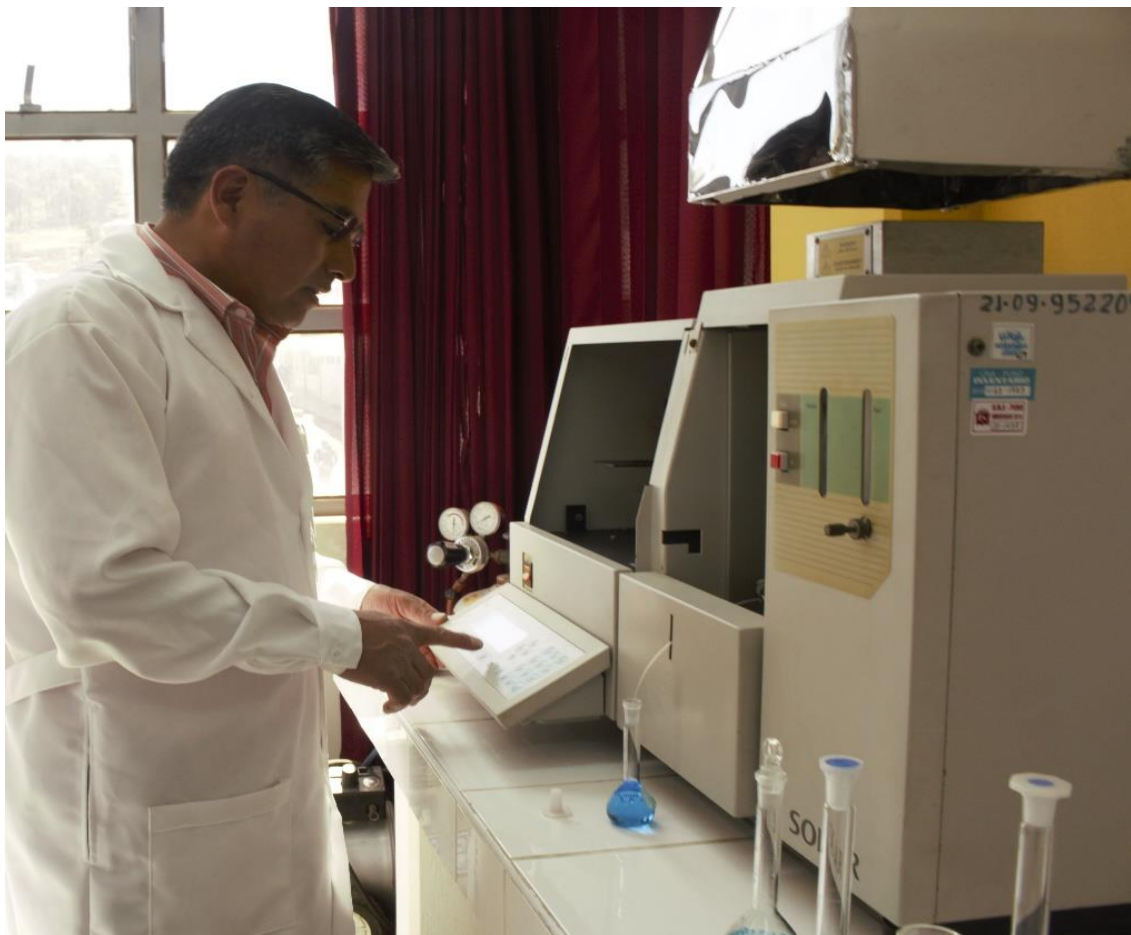
Figura 11. Análisis de cobre por espectrofotometría de Absorción Atómica
