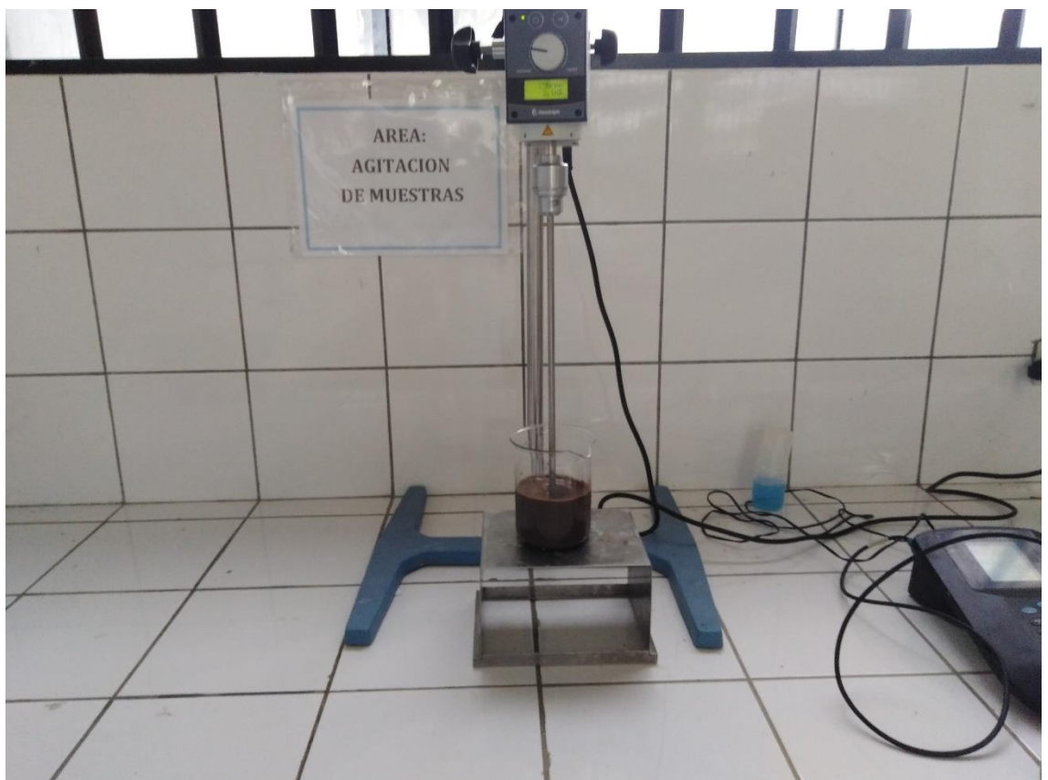
Foto B.3: Lixiviación de mineral de cobre por el método de agitación
