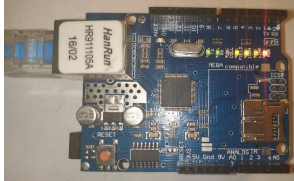
Figura 3.11: Conexión de Ethernet Shield al Arduino UNO y prueba de funcionamiento.
