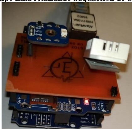
Figura 3.32: Prototipo final realizando adquisición de datos de los sensores.
