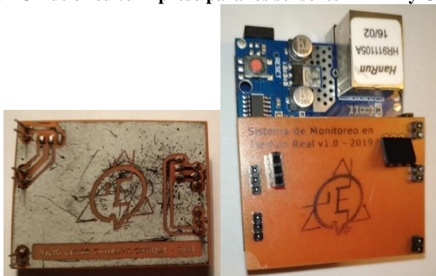
Figura 3.31: PCB de circuito impreso para los sensores DHT22 y GUVB-S12SD.
