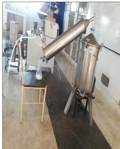
**Figura 10.** Extracción del aceite esencial de canela por el método de arrastre de vapor de agua. En el Lab. De Talles de Frutas y Hortalizas, noviembre 2018
