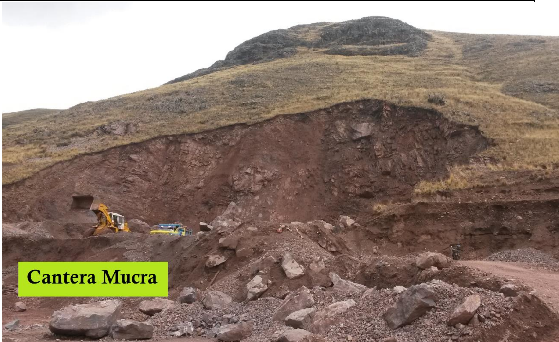
FOTO 01: La cantera se muestra NS. Formación Calapuja, con material lastre y Roca con diferentes tamaños de bloques.
