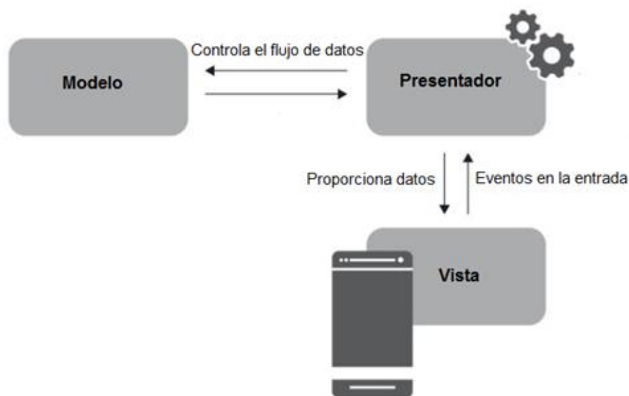
Figura 4.11: Aplicación con MVP. Arquitectura
