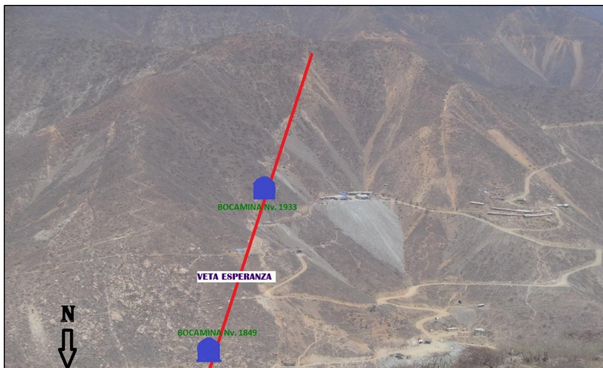
Figura 7: Se observa una serie de vetas auríferas paralelas de rumbo N-S con buzamiento subvertical, zona La Aguada.
