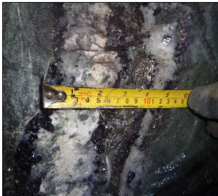
Figura 4: Estructura mineralizada de 12 cm de potencia con presencia de sulfuros diseminados en veta de cuarzo.
