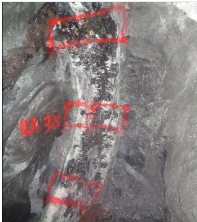
Figura 24: Muestreo por canales en labores de desarrollo.
