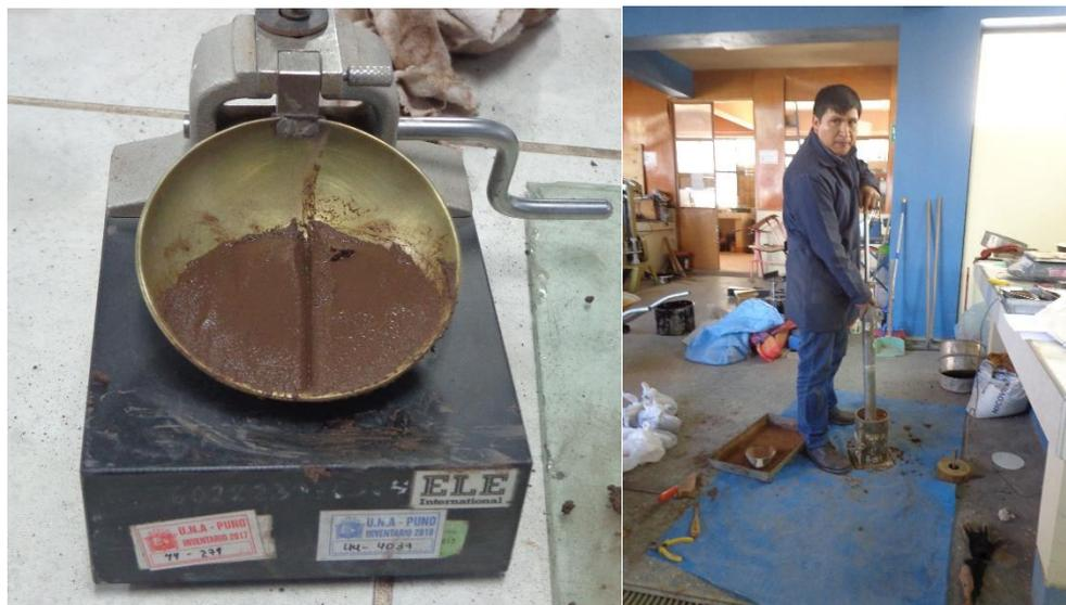
Figura N° 16: Ensayo de Limite Líquido y CBR de la calicata C-3
