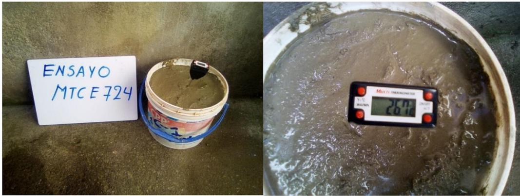
Figura N° 27: Temperatura máxima de fraguado
