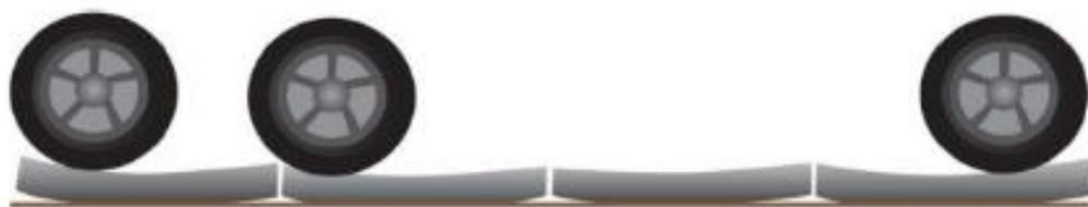
Figura N° 6: Distribución de set de ruedas en losa de concreto
