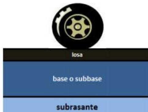
Figura N° 1: Esquema de pavimento rígido
