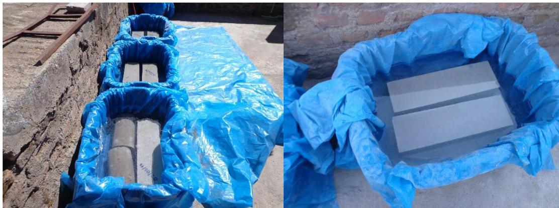
Figura F.7: Curado de especímenes cilíndricas y prismáticas
