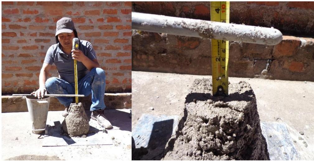
Figura F.8: ensayo de asentamiento en concreto fresco
