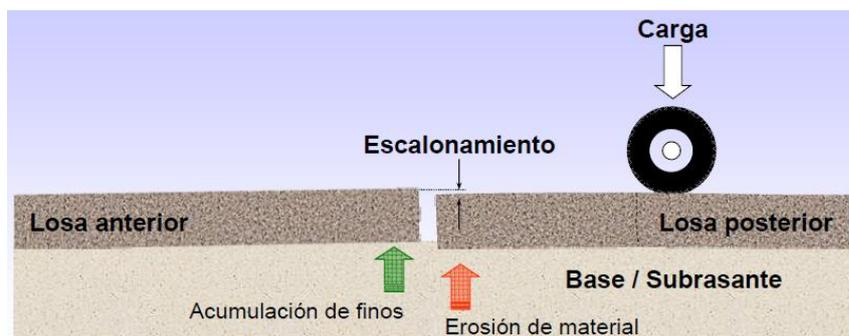
Figura N° 13: Escalonamiento en la Junta
