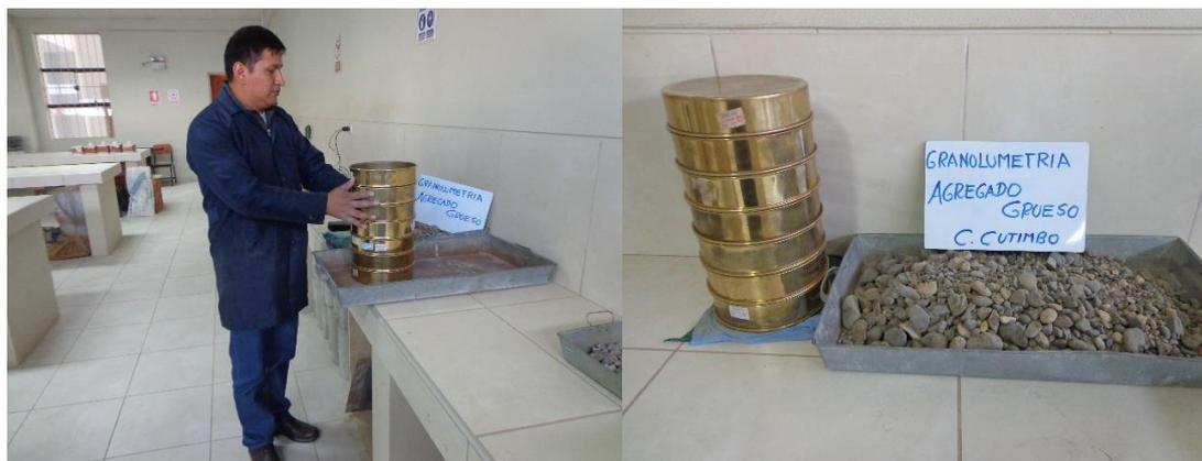
Figura F.4: Tamizado del agregado grueso
