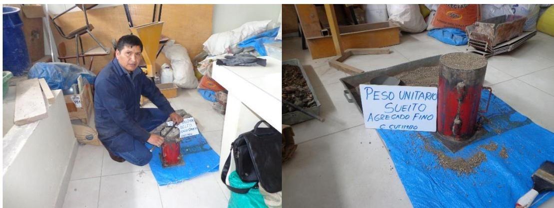
Figura F.3: Proceso de ensayo peso unitario de agregados
