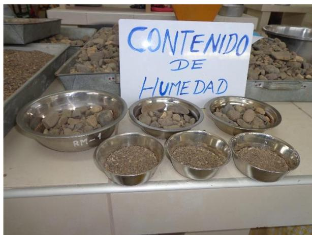
Figura F.2: muestras para w (%) del agregado fino y grueso
