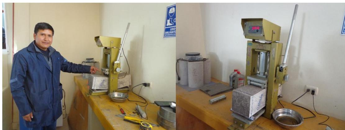
Figura F.10: Ensayo de resistencia a flexión en laboratorio de construcción EPIC-UNAP
