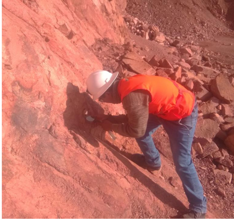
Foto 7: Medicion de direccion de buzamiento con la brujula
