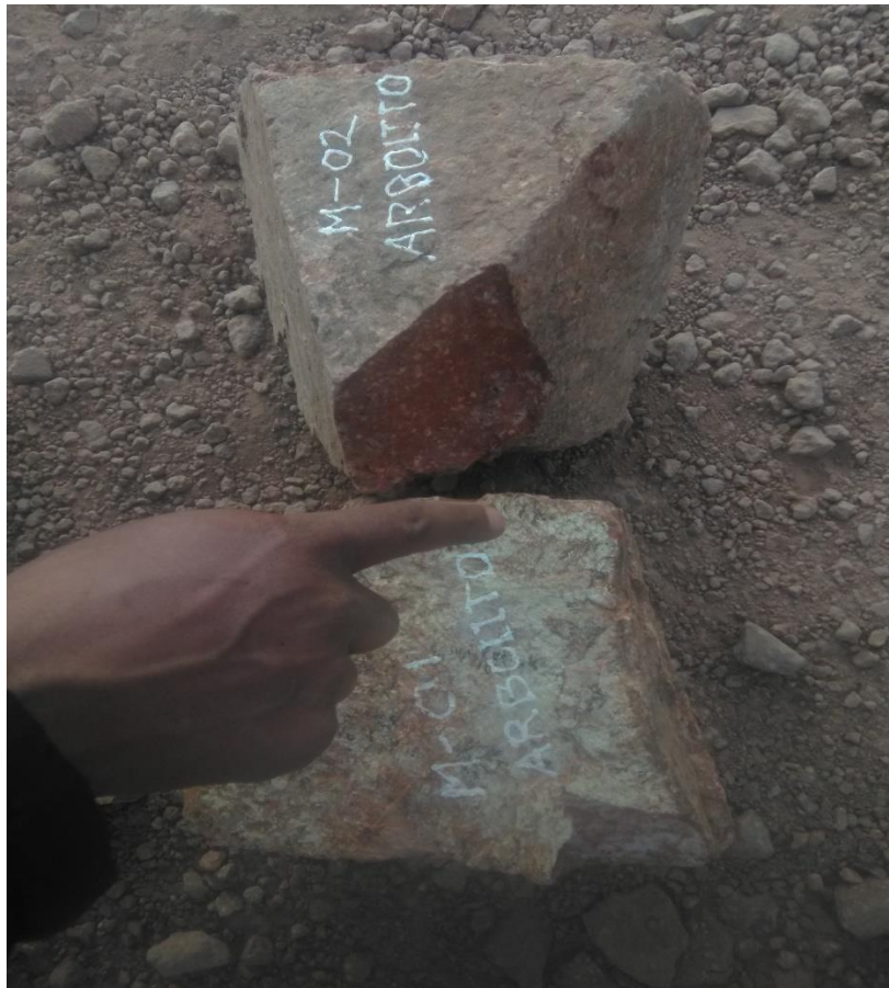
Foto 8: toma de muestra de la roca intacta para el ensayo de laboratorio
