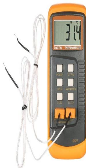
**Foto N°08** *Realizando las mediciones temperaturas a nivel de superficie con el instrumento de termómetro digital tiene un rango de( -50°C hasta 1000°C).*
