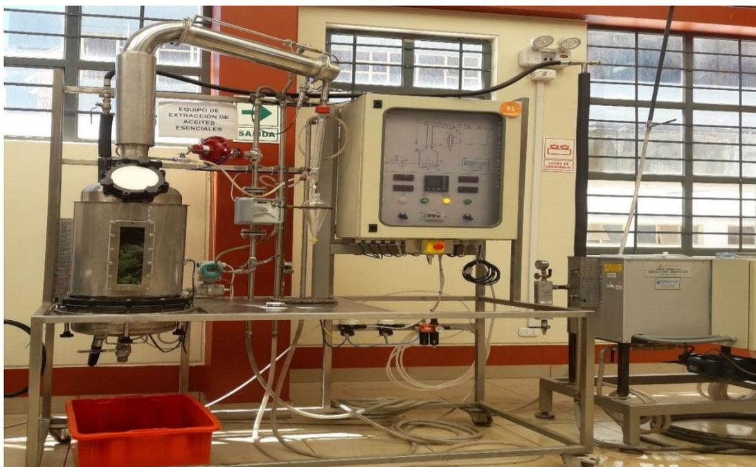
Figura B1: Equipo de Extracción de aceite esencial por arrastre de vapor
