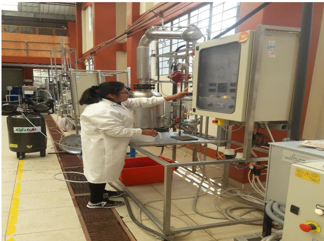
Figura B7: Lectura de datos de las temperaturas de la extracción del aceite esencial.
