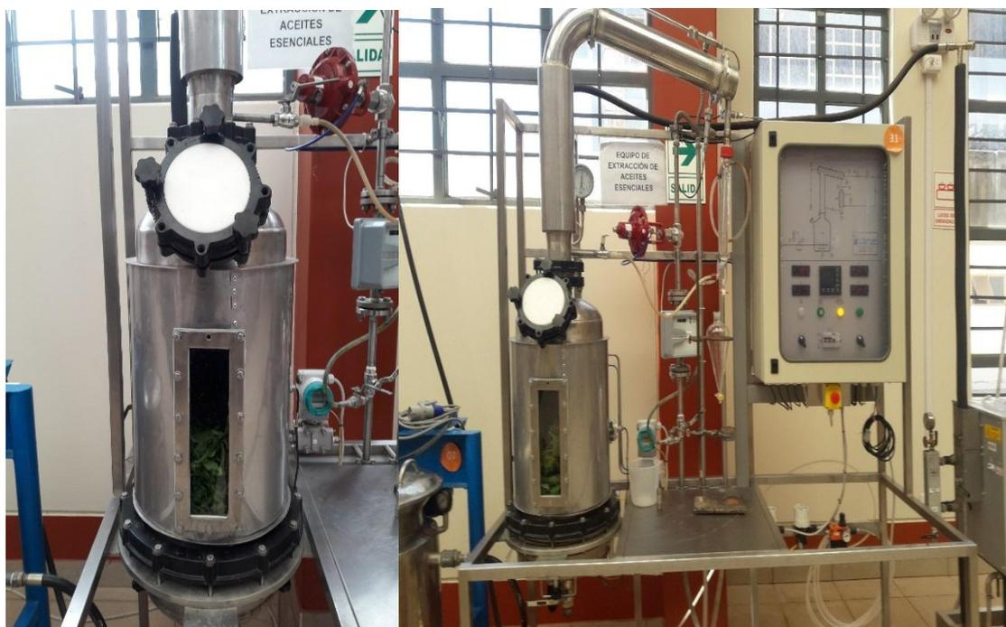
Figura B6: Iniciación de la extracción del aceite esencial (*Spinacia Oleracea L.*).
