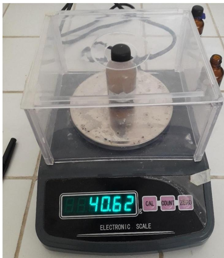
Figura B12: Pesado de muestra del aceite esencial de espinaca (*Spinacia Oleracea L.*).
