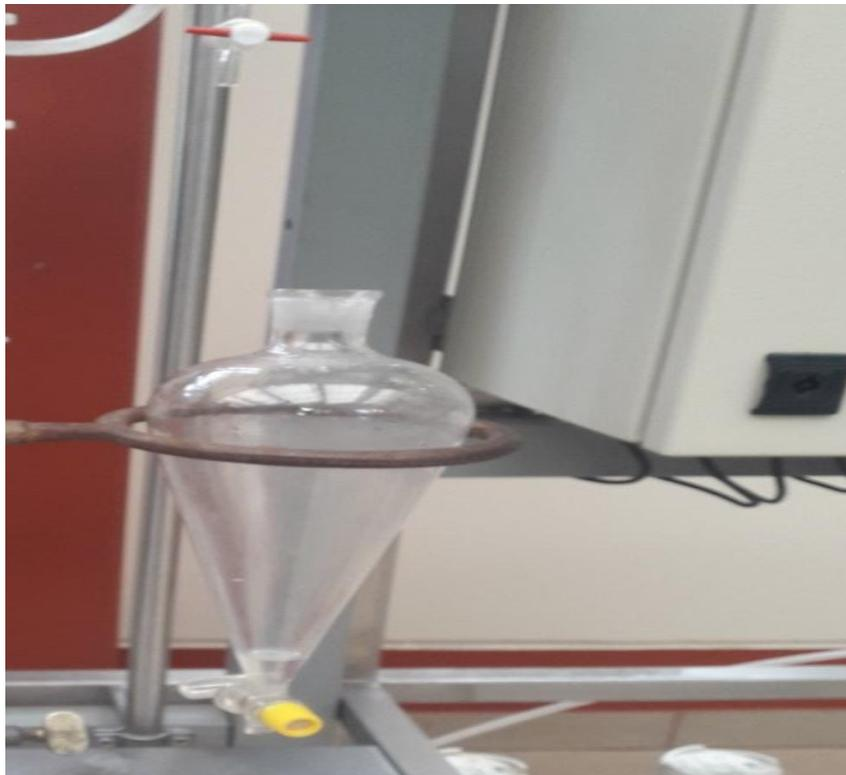
Figura B10: Decantación del aceite esencial (separación del agua y el aceite).
