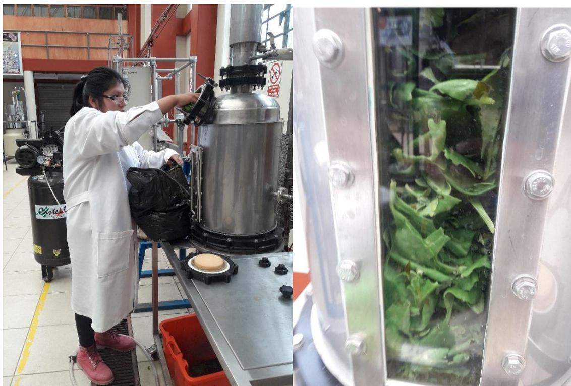
Figura B5: Muestra de materia prima espinaca (*Spinacia Oleracea L.*) Incorporación en recipiente destilador.
