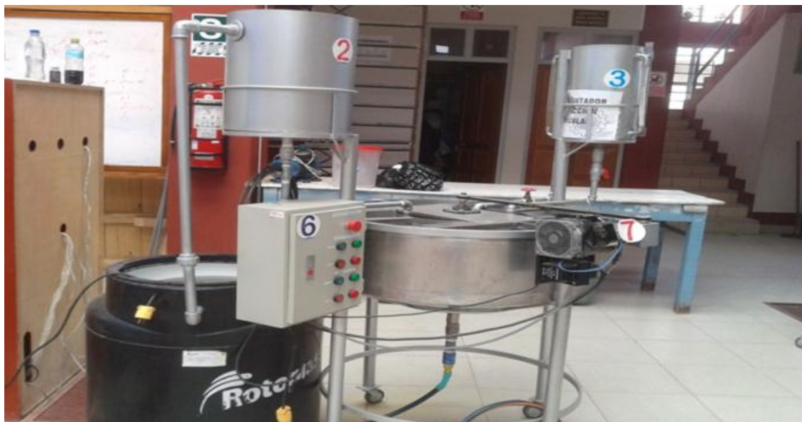
Figura 14: Sedimentador de flujo ascendente de sección cilíndrica.
