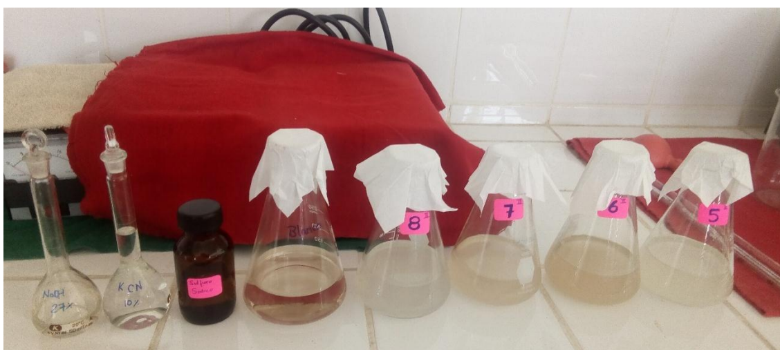
Figura C6: muestras añadidas con reactivos listas para ser leídas en el espectrofotómetro UV-V-IR
