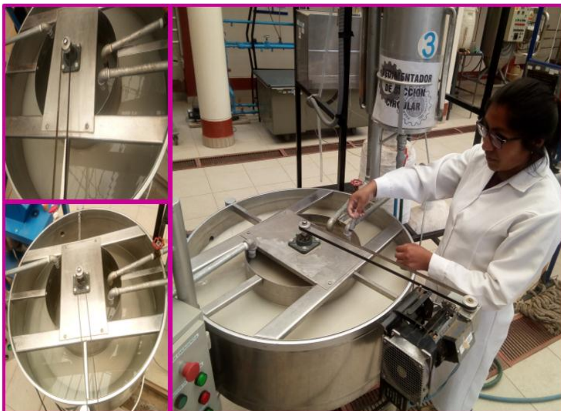
Figura C11: Pruebas en el equipo de sedimentador de flujo ascendente
