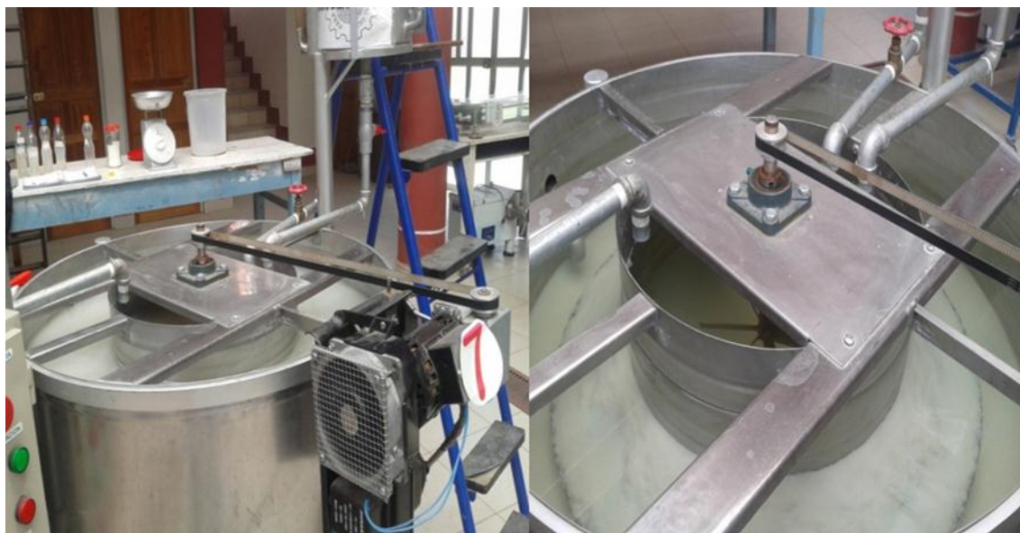
Figura 15: Componentes del reactor sedimentador de flujo ascendente.
