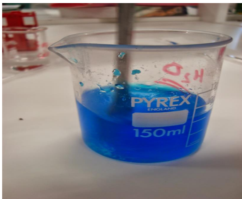
Figura N° 4. 1 Varillas de hierro cubiertas por la solución de sulfato de cobre
