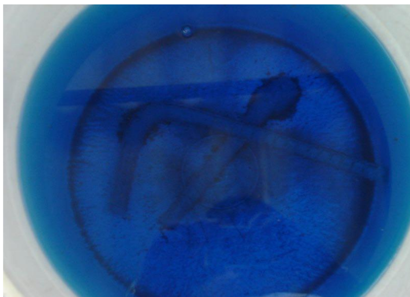
Figura N° 4. 2 Acumulación de cobre en las varillas de hierro
