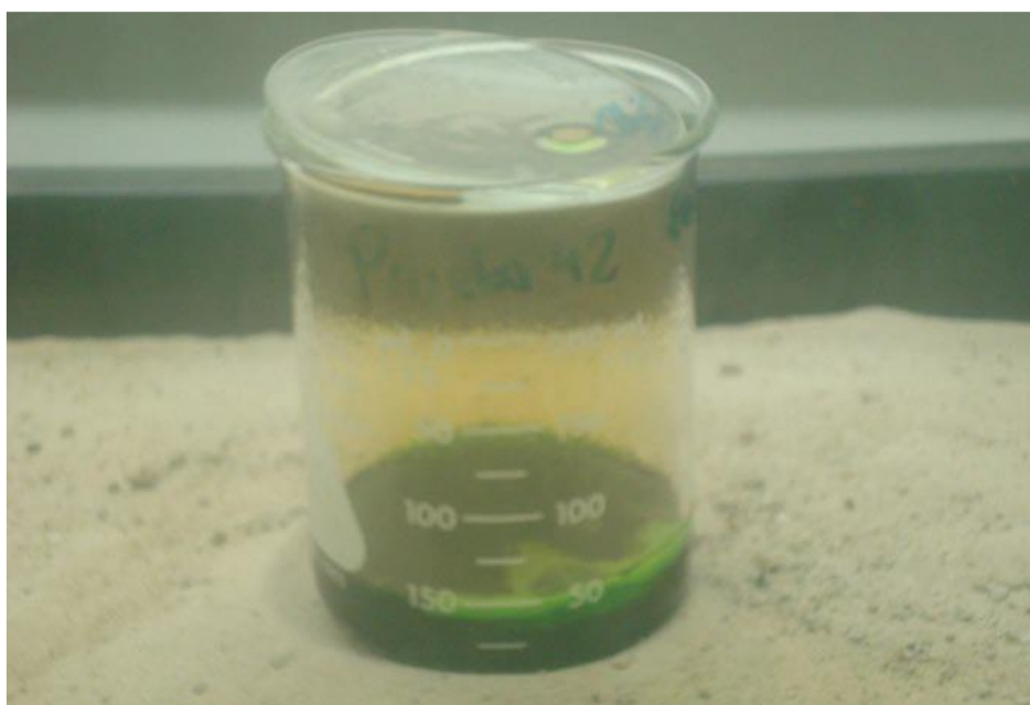
Figura N° 4. 13 fase metálica durante la disgregación en ácido nítrico diluido
