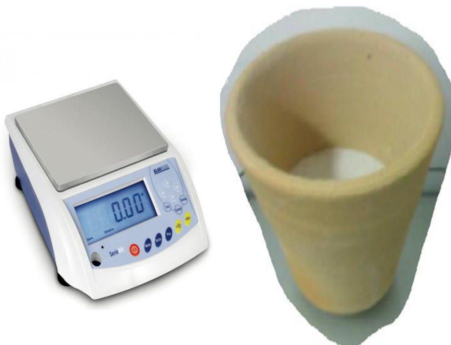
Figura N° 4. 8 Crisol que contiene la carga fundente colocado sobre una balanza analítica,
