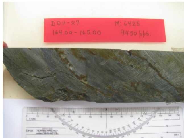
Figura N° 40. DDH-27, MUESTRA 6425 (164.00 m a 165.00 m) Venillas discontinuas y parches de Qz- Po>Apy>St>Py. Leyes de 9.45 g/t Au, 0.319 % As, 0.429 % Sb
