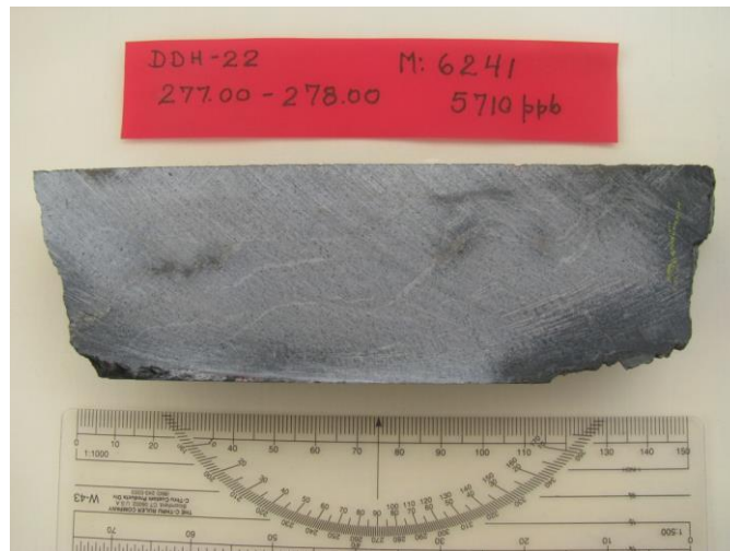
Figura N° 39. DDH-22, MUESTRA 6241 (277.00 m a 278 m) Micropliegues con Po>Apy>Py. Leyes de 5.7 g/t Au, 0.563 % As, 2.85% Sb
