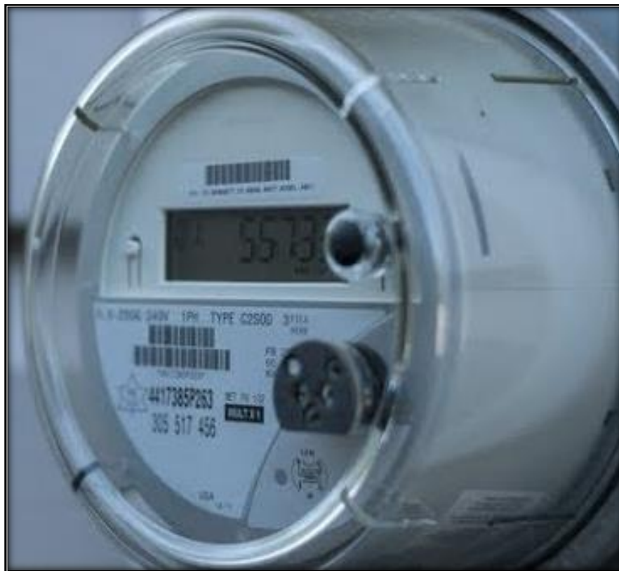
Figura N° 2.6: Cubierta de policarbonato del Medidor.
