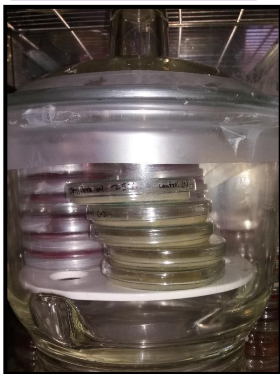
Colocación de las placas Petri dentro de la cámara de anaerobiosis
