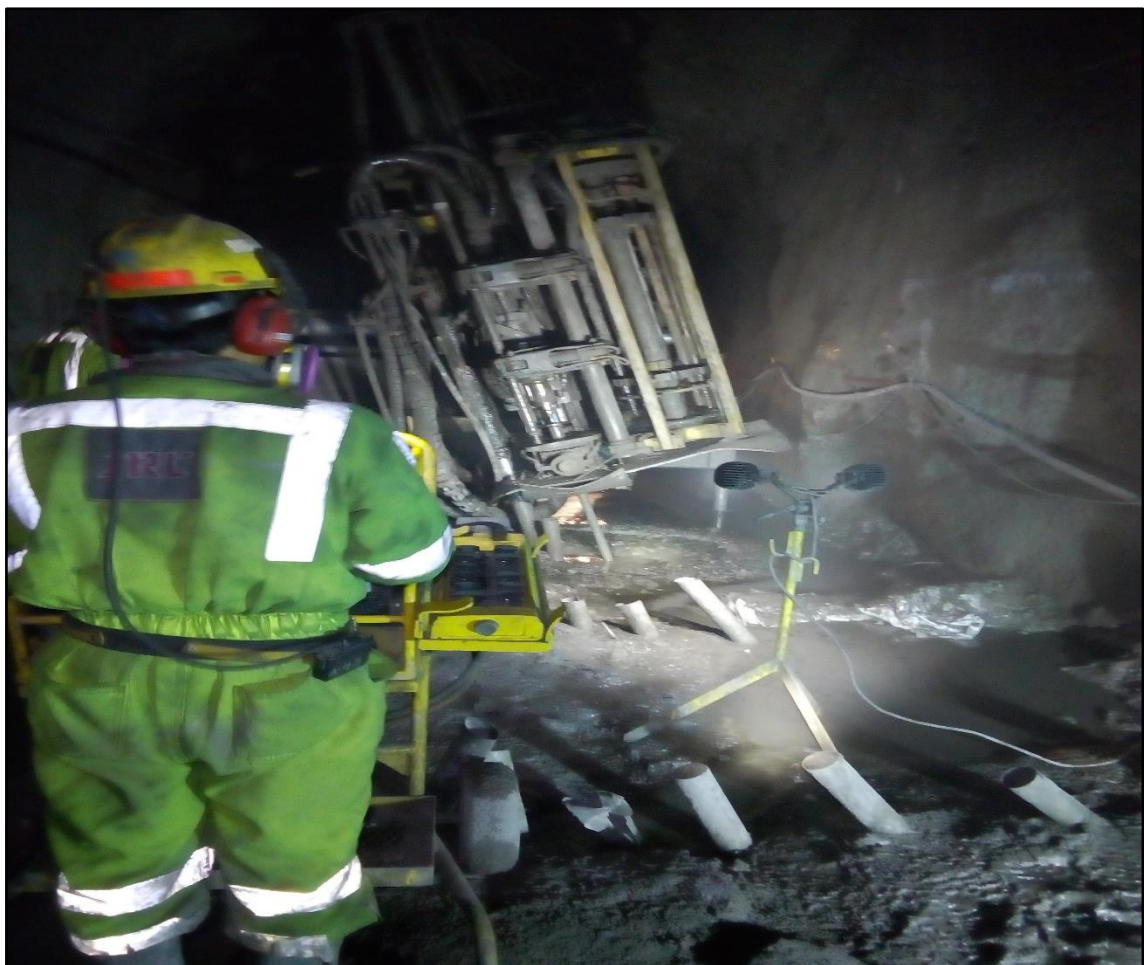
ANEXO N° 4: Perforación de taladros largos en descendente
