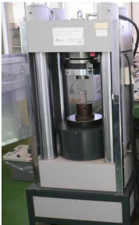
**Figura 8:** Ensayo de compresión simple
