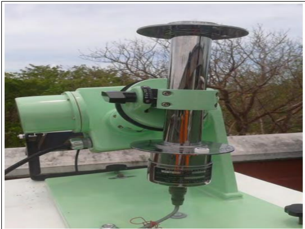
Figura 8. Pirheliómetro para la medición de la radiación solar directa
