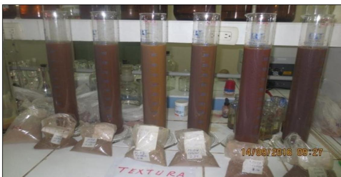
**Figura 7.** Determinación de la Textura de los Suelos
