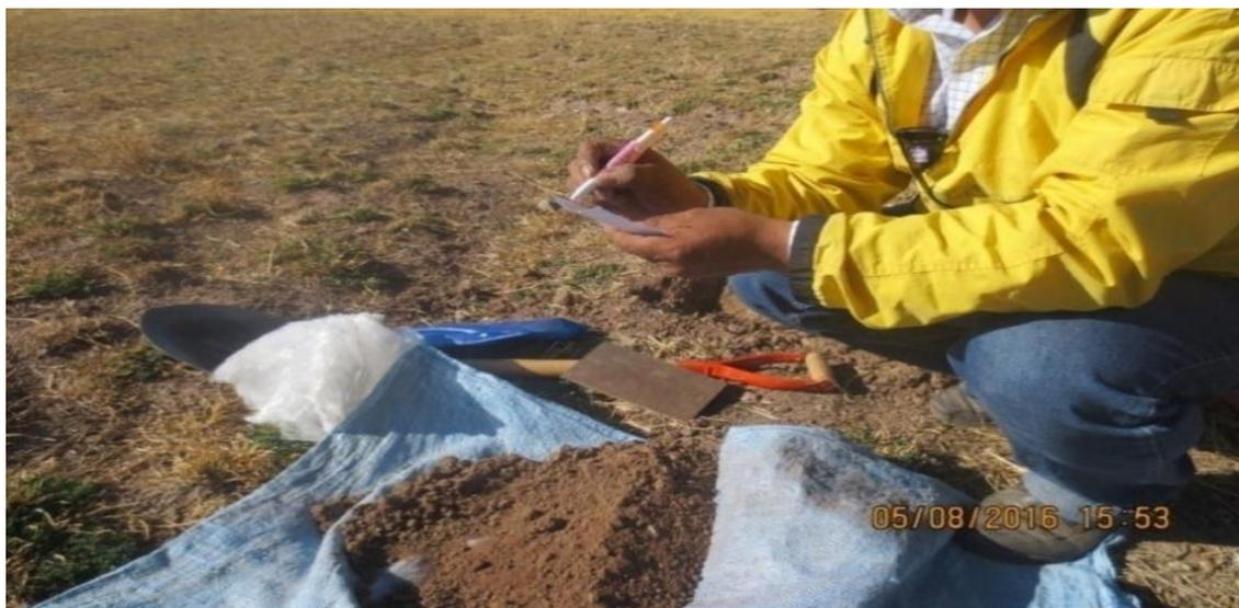
**Figura 5.** Identificación y peso de muestra
