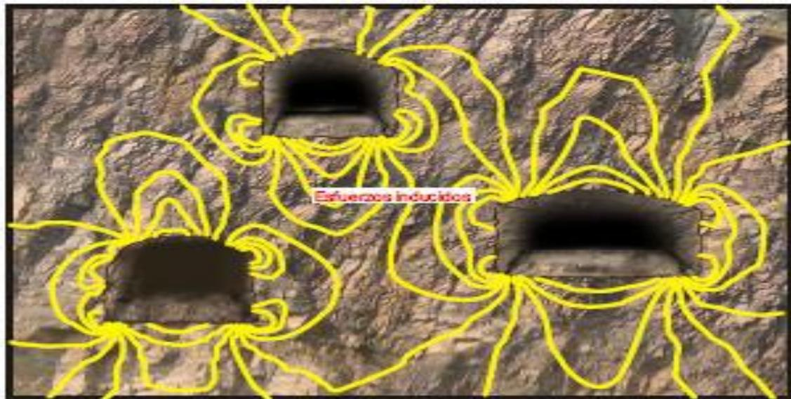
**Figura 10:** Gráfico de estado tensional después de la excavación.
