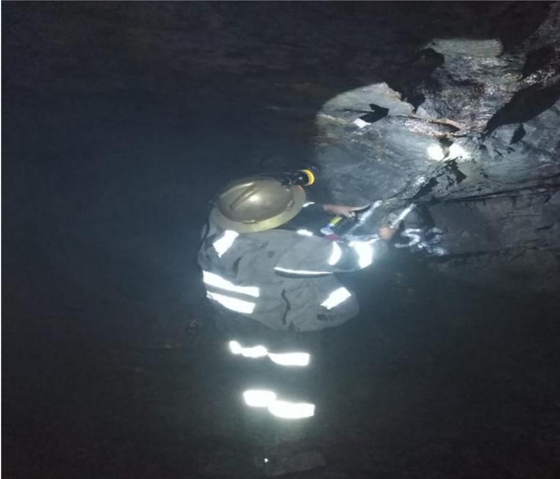
**Foto 7:** Caracterización geomecánica de la falla.
