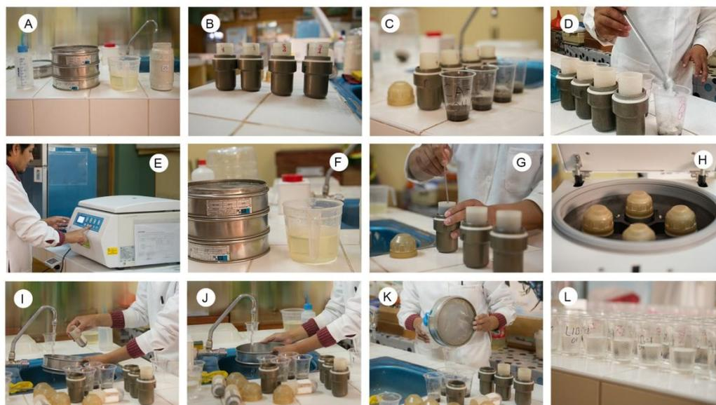
**Figura 18:** (A) Pipeta, Tamiz, Sacarosa, Cal, (B) Tubos de centrifuga, (C) Tubos y vasos con muestras marcados para centrifugación, (D) Vasos con caolín, (E) Centrifuga (F) Solución Sacarosa, (G) Muestras con sacarosa siendo Homogenizado, (H) Tubos listos para centrifugado, (I) Lavado (J) Tamizado, (K) Recolección, (L) Muestras listo para identificación. (Fuente: Fotos de la Investigación, 2019)
