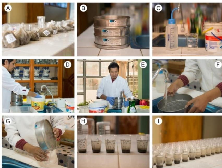
**Figura 17:** (A) Muestras de Suelo, (B) Tamices de 60, 100, 400 Mesh, (C) Pipeta, Becker 250 cm<sup>3</sup>. Balde, (D) Homogenización de la muestra, (E) Tamizado (F) Lavado, (G) Recolección de la muestra, (F) Vaso con muestras de suelo, etiquetado, (I) Total de las muestras lavadas. (Fuente: Fotos de la Investigación, 2019)
