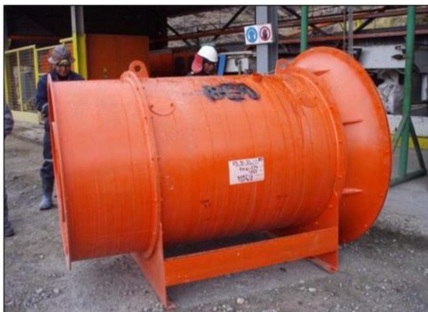
Ilustración 6 : Ventilador de 25 000 CFM
