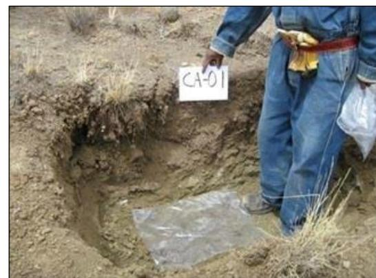
**Figura 2.** Extracción de muestra 01 de suelo
