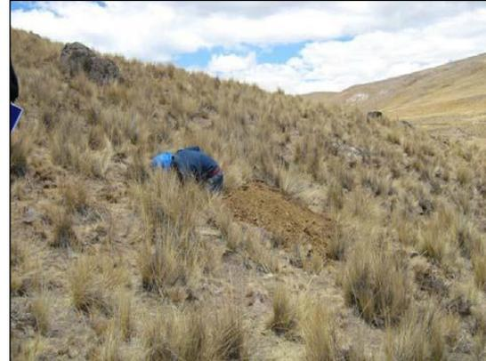
**Figura 1.** Apertura de calicata para muestreo de suelos
