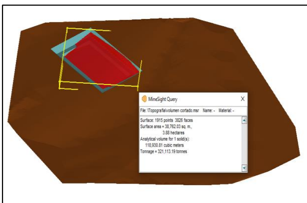
Figura 9. Calculo de volumen de corte mediante el programa MineSight.
