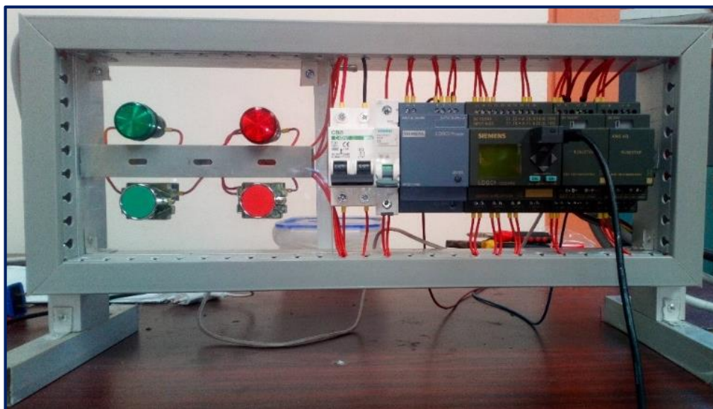
Figura 3.14: Estructura y armado del módulo de control
