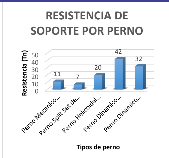
Figura 11. Tipo de perno vs resistencia de soporte
