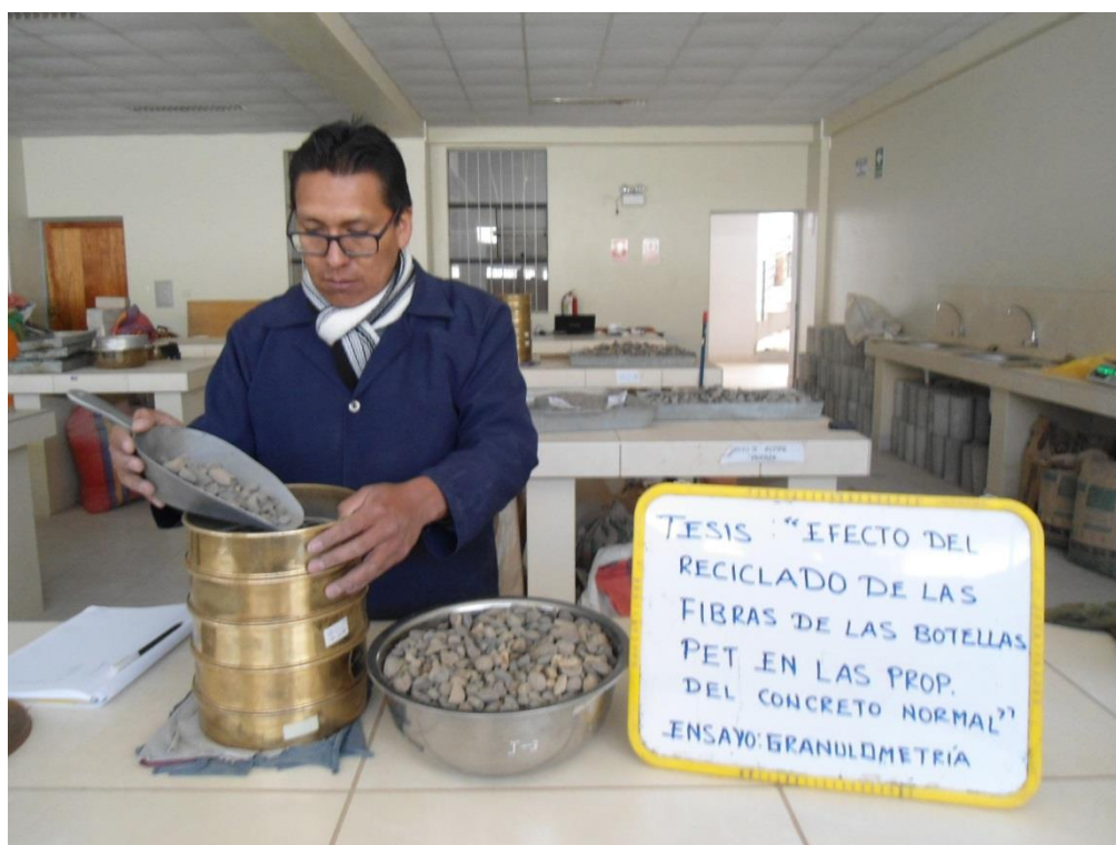
Figura 13. Ensayo de granulometría del agregado grueso
