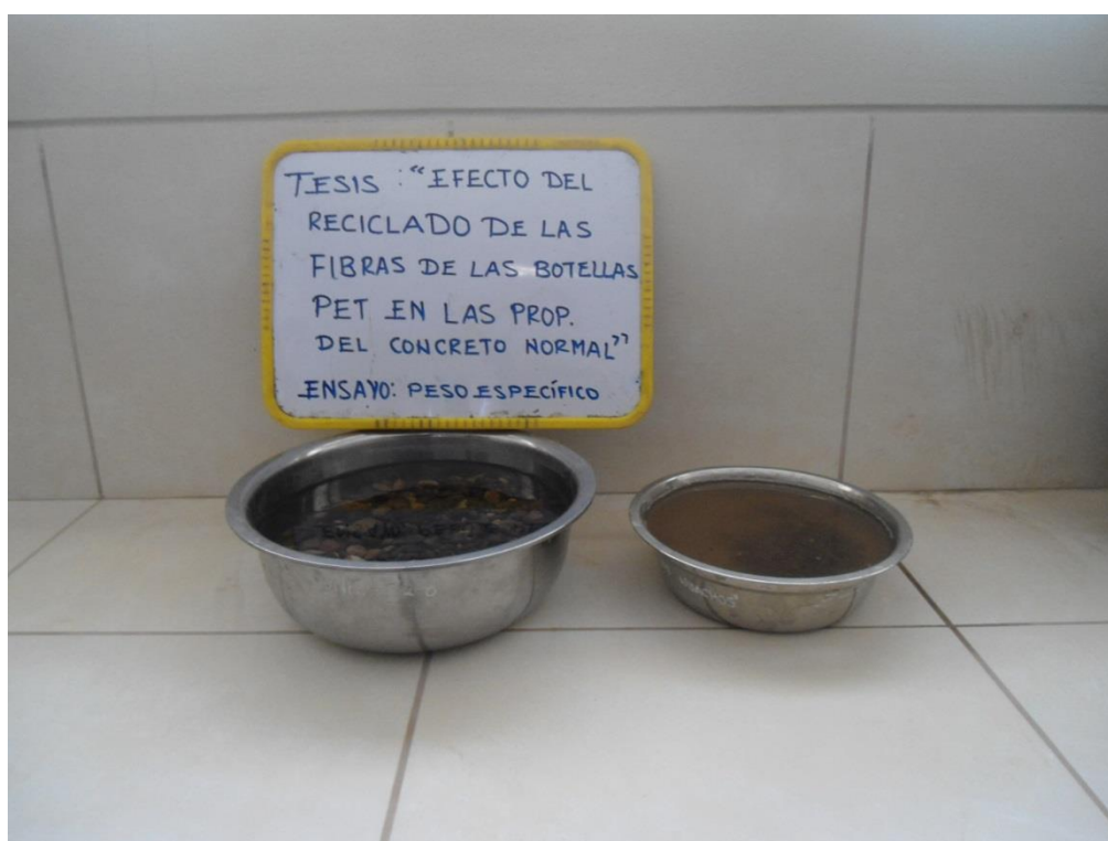
Figura 14. Ensayo de peso específico y absorción de los agregados
