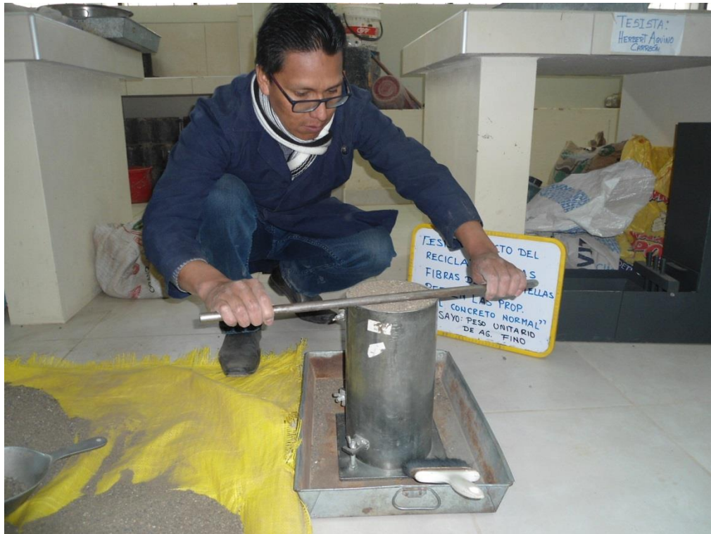
Figura 17. Determinación de peso unitario del agregado fino
