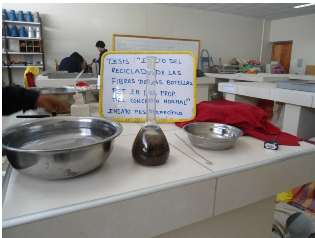
Figura 15. Ensayo de peso específico y absorción del agregado fino
