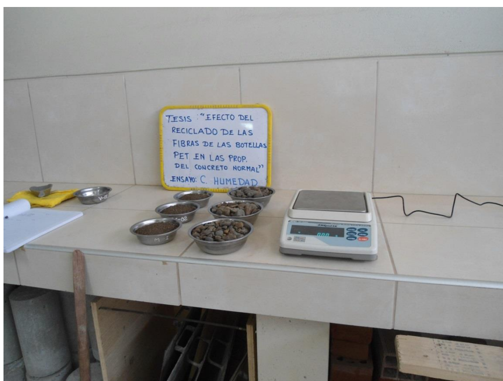
Figura 16. Ensayo de contenido de humedad de los agregados
