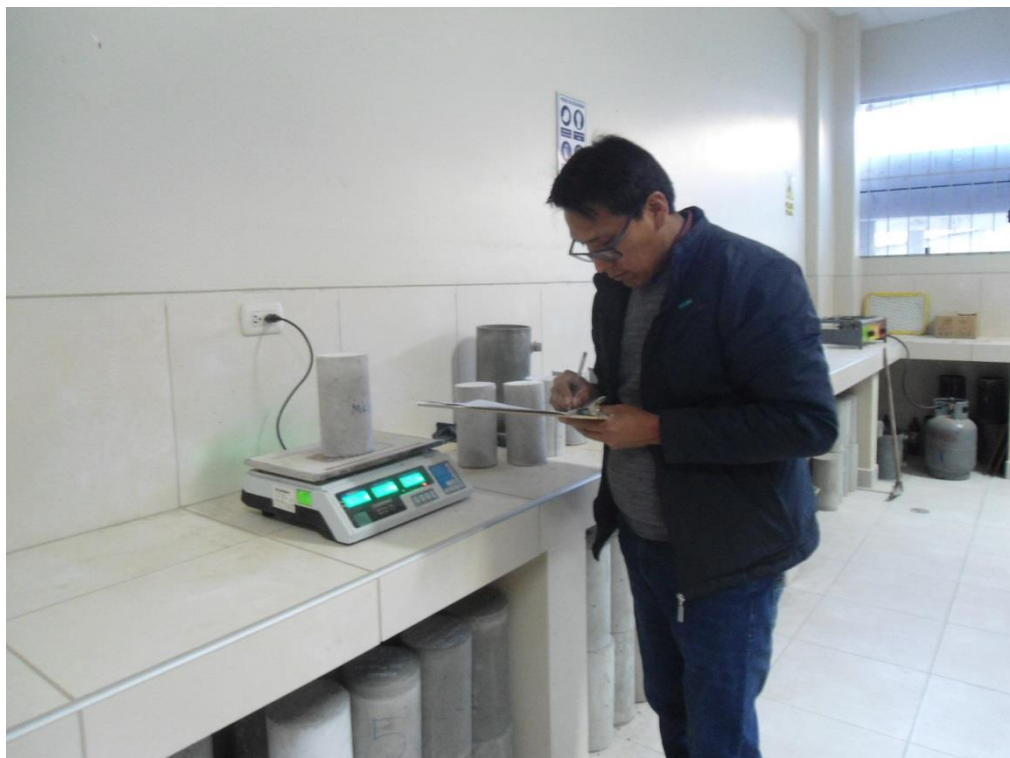
Figura 22. Determinación del peso de los especímenes a los 28 días de curado
