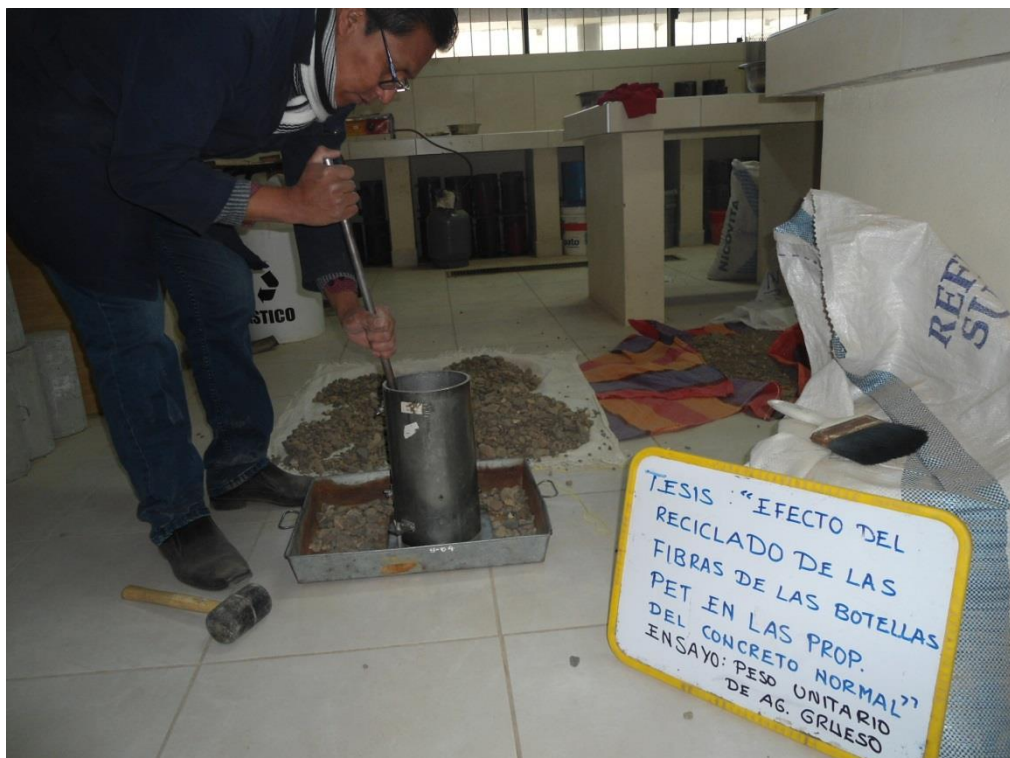
Figura 18. Determinación de peso unitario compactado del agregado grueso
