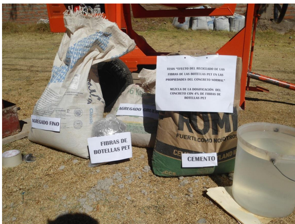
Figura 20. Materiales para dosificación del concreto con fibras de 4% de PET
