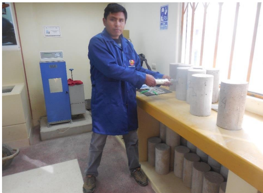
Figura 63. Ensayo de esclerometria a las probetas.
