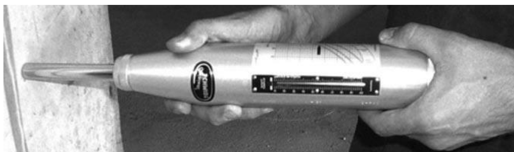
Figura 17. Martillo Schmidt para la obtención del índice de rebote.
