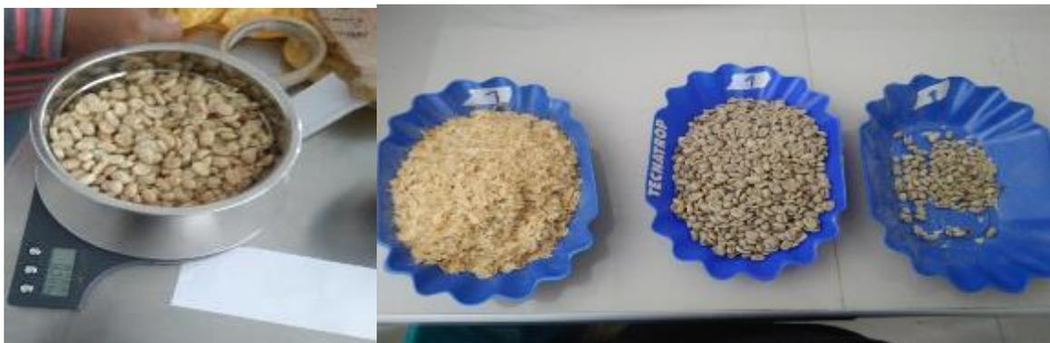
**Figura 42.** Peso muestra de café 300g y peso de cascara y grano deforme.
