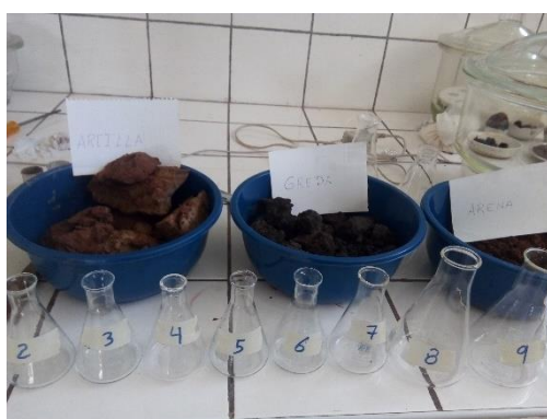
Figura 11: Codificado de matraces y pesado de las muestras para la determinación el porcentaje de humedad de la materia prima
