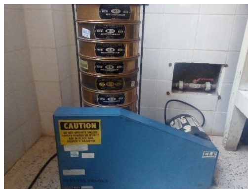
Figura 15: Tamizado de la Mezcla de Arcilla, Greda, Arena
