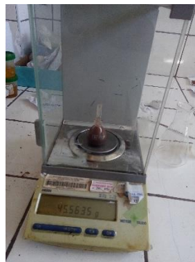
Figura 12: Pesado del Picnómetro + Agua + Muestra
