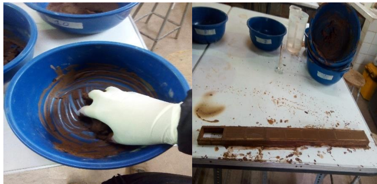
Figura 20: Colocado de la Mezcla en molde y Esparcido dentro del Molde Luego de mezclado y moldeado las muestras probetas de ladrillo fueron codificadas como A, B, C, D, E, F, G, H, I, J, para poder diferenciar entre ellas.
