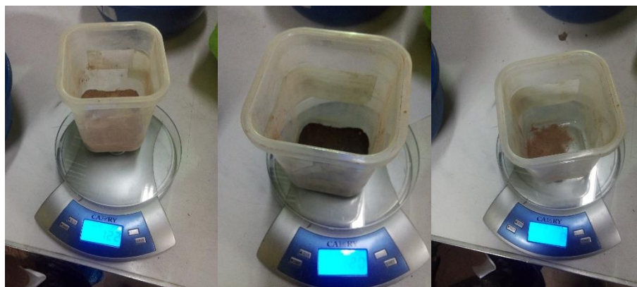
Figura 17: Peso de la materia prima: Arcilla, Greda, Arena, en la balanza digital
