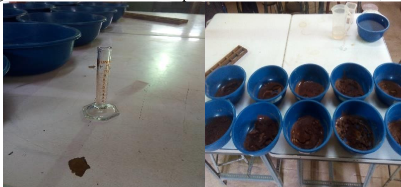
Figura 19: Adición de Agua a cada uno de los Proporciones de la Mezcla
