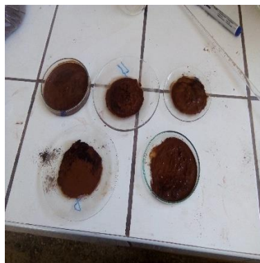
Figura 13: Remojado de las Muestras con Ácido Sulfúrico
