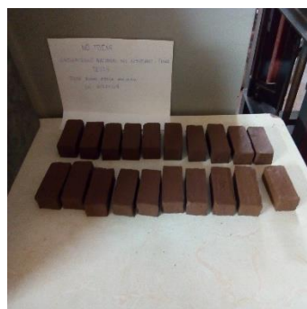
Figura 21: Secado de las Muestras de Ladrillo a Temperatura Ambiente
