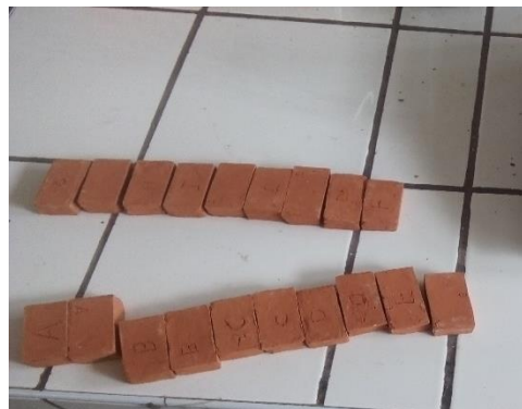
Figura 23: Secado de las Probetas a Temperatura Ambiente
