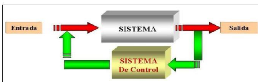
Figura 2.13. Sistema de Control de Lazo Cerrado
