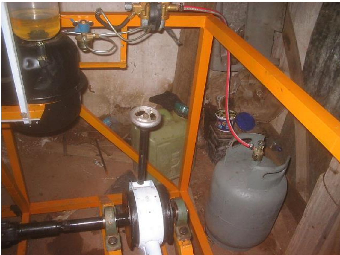
Figura 28: Kid de conversión con suministro de GLP.
