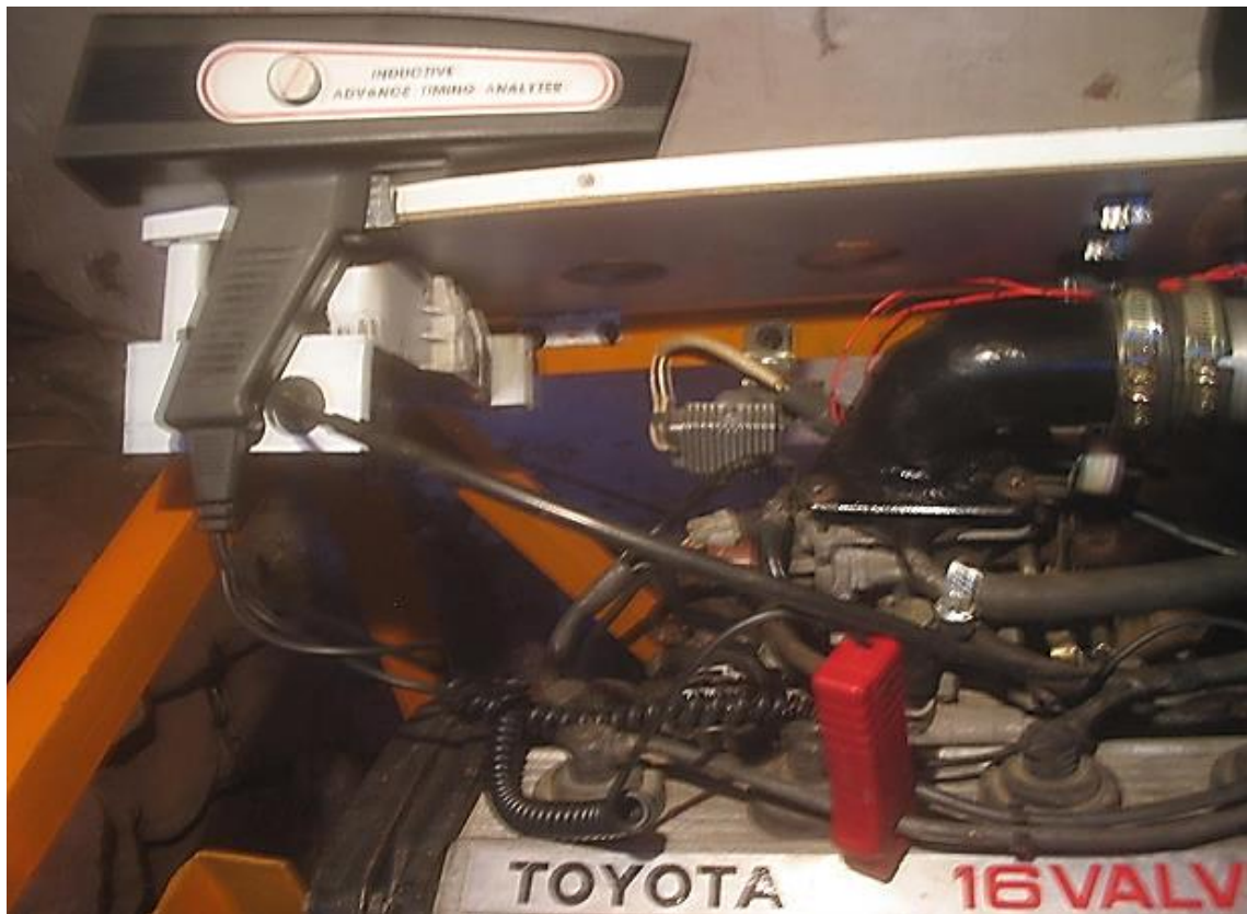
Figura 34: Contador de revoluciones inductive advance timing analyzer, conectado al terminal de la bujía con conector electromagnético.
