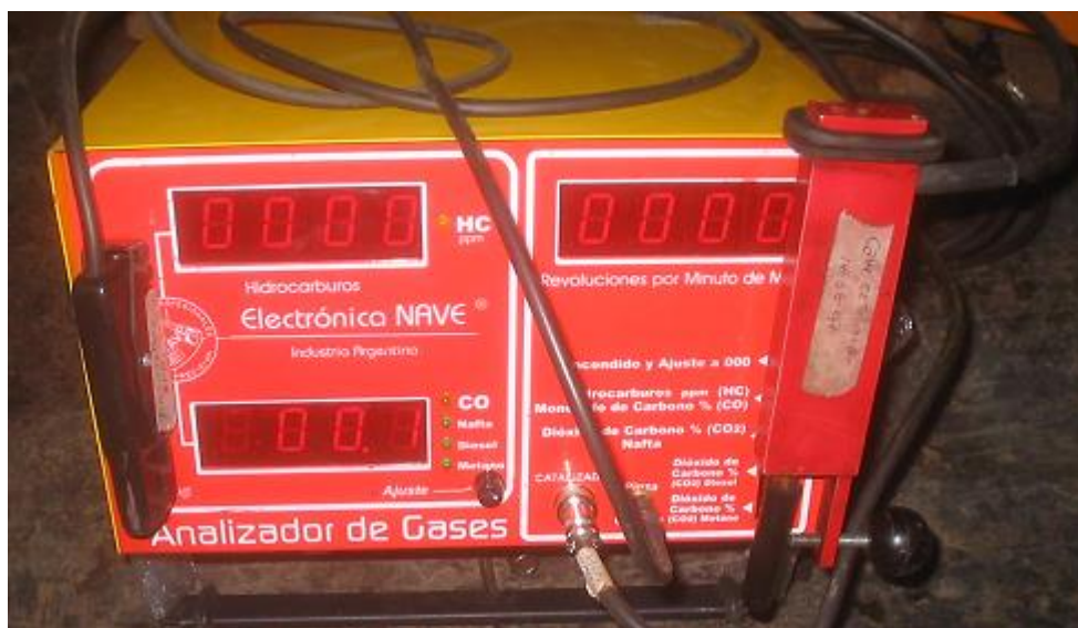
Figura 33: Analizador de gases para la toma de muestras.
