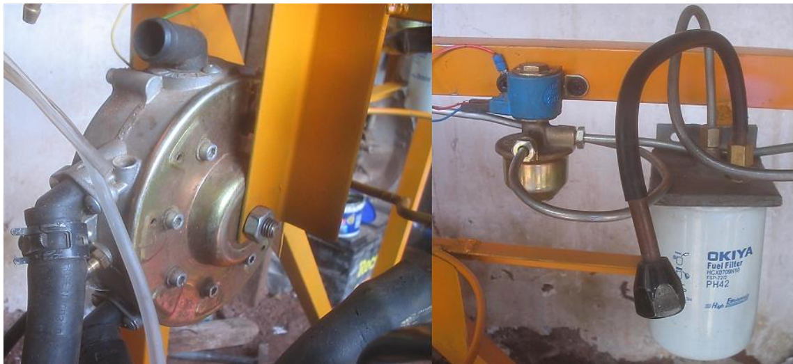
Figura 27: Kid de conversión instalado en la estructura.
