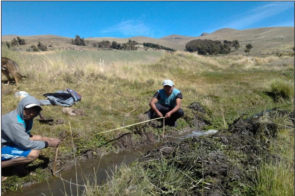
Dimensionamiento de secciones de la longitud de río
