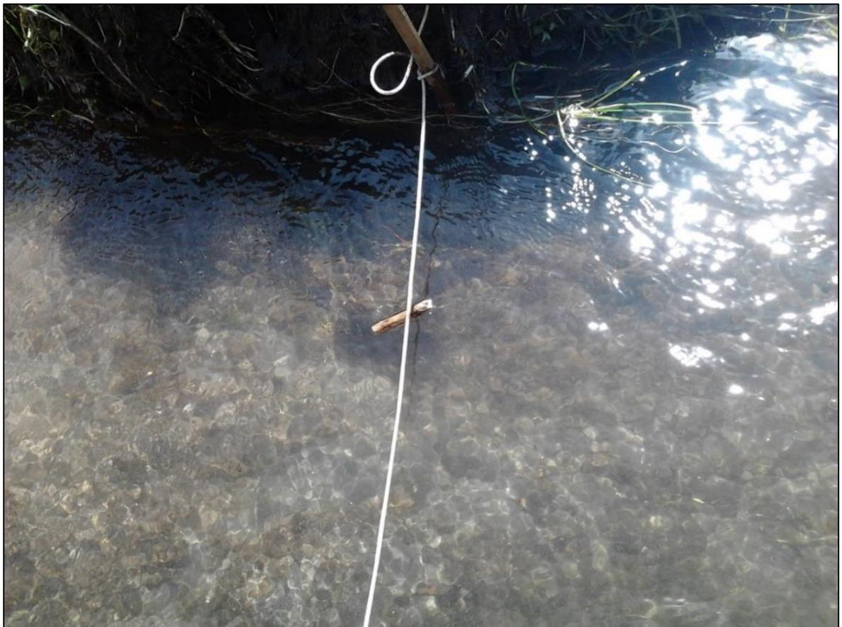
Calculo de caudal por método de flotador
