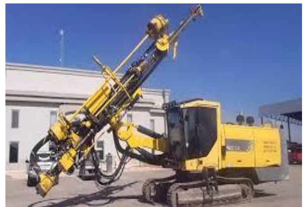
Figura 4. Sobre Orugas. Fuente: Atlas Copco.
